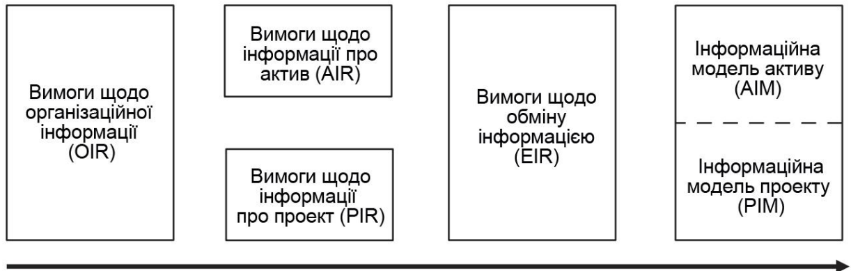
Рисунок 2 – Спрощений приклад послідовності формування вимог щодо інформації
