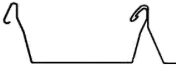
Рисунок 7 – Типовий профіль із стоячим фальцем Figure 7 – Typical standing seam profile
