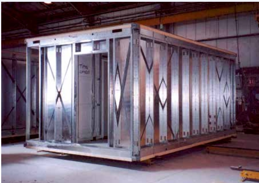
Рисунок 6.2 Типовой несущий модульный блок здания Terrapin
