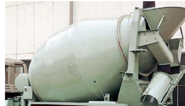
Миксер бетономешалки (окрашенный атмосферостойкий прокат)
