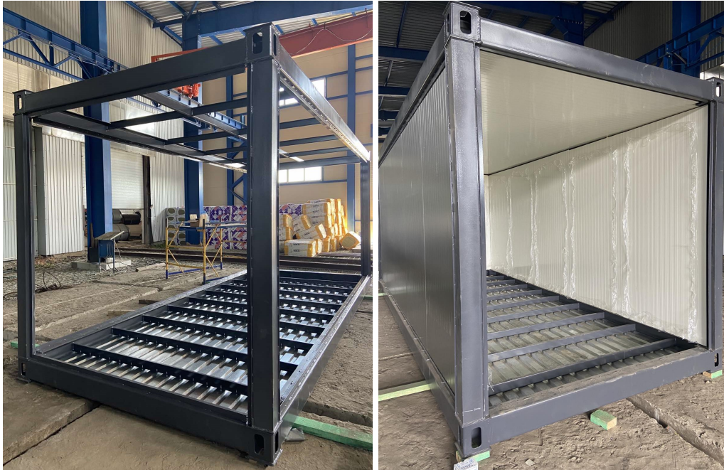
Загальний вигляд зварного каркасу блок-контейнера типу 1 з такелажними творами, у процесі виготовлення
