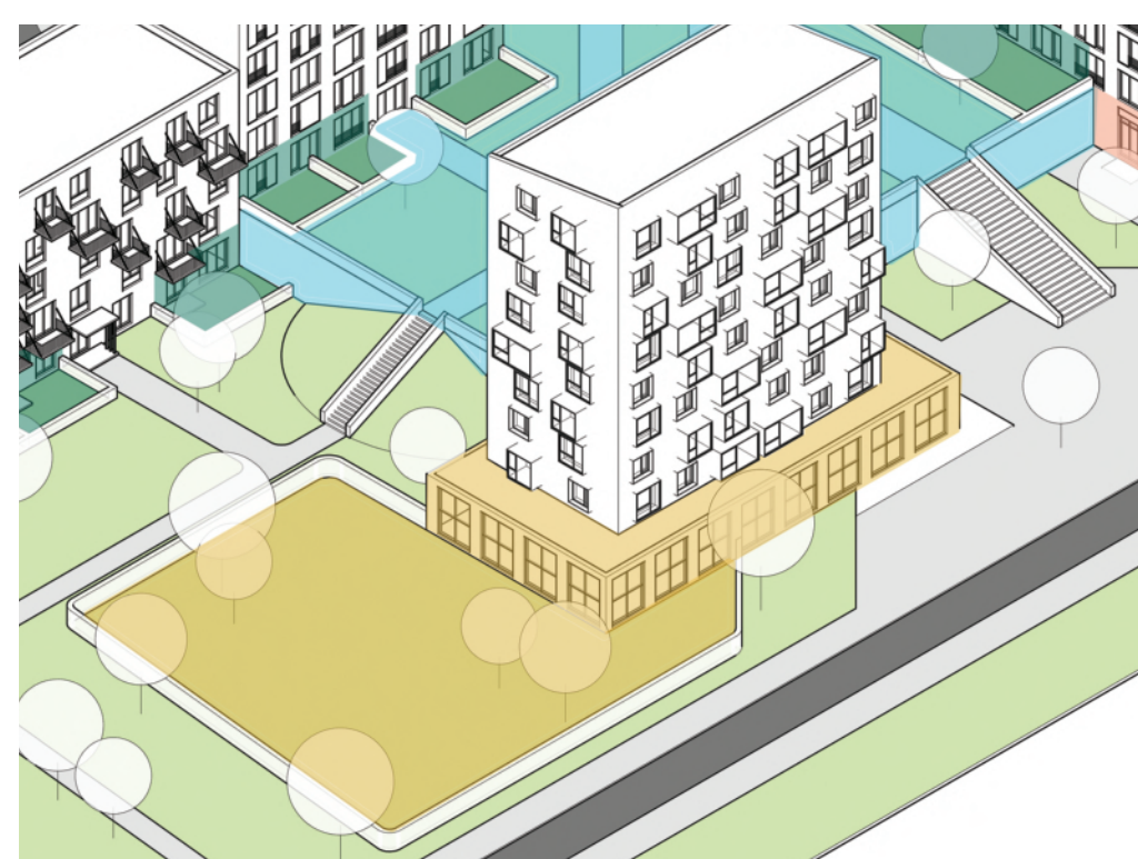
Вбудований дитячий садок на першому поверсі житлового будинку. Економить простір, та наповнює життям дворові простори.
