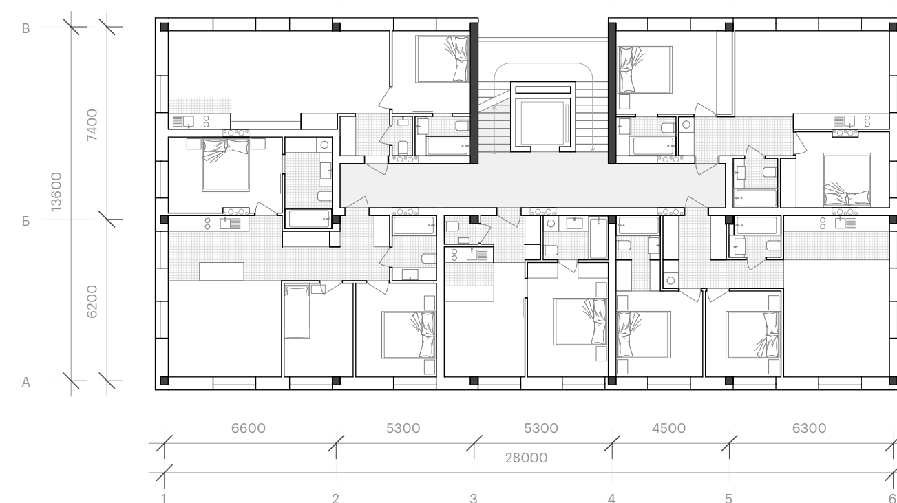
План третьего этажа 1:200
