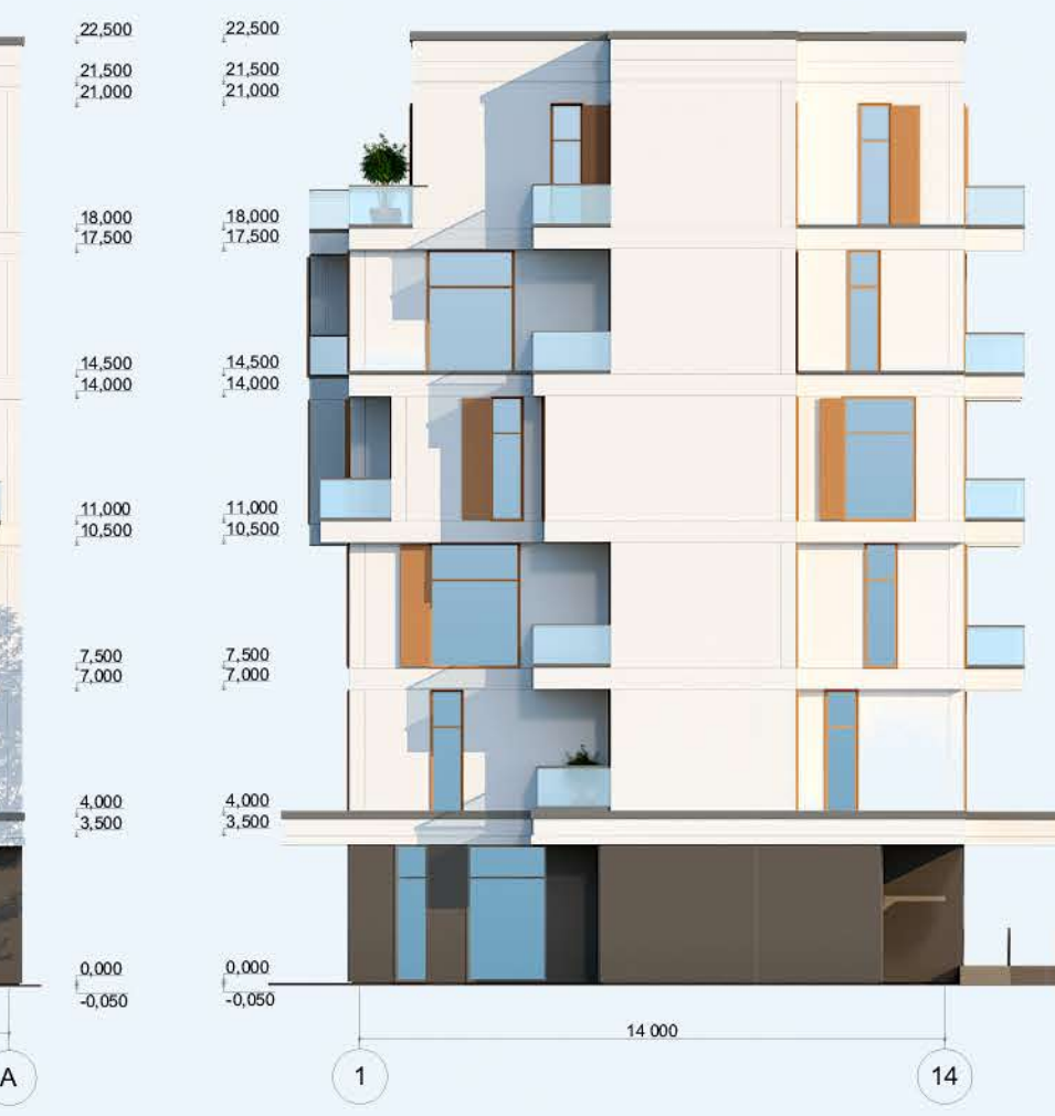
Фасад у осях 1-14, М 1:200
