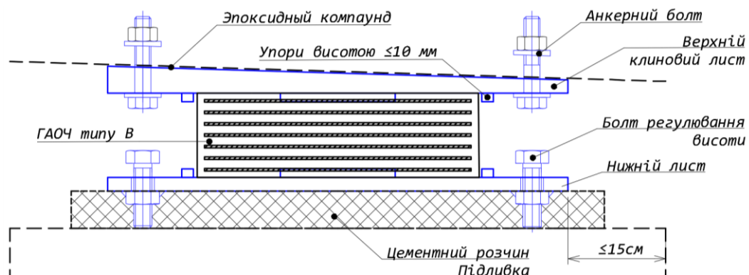
Рисунок Р.8 – ГАОЧ типу В. Схема установки в сталевій обоймі
