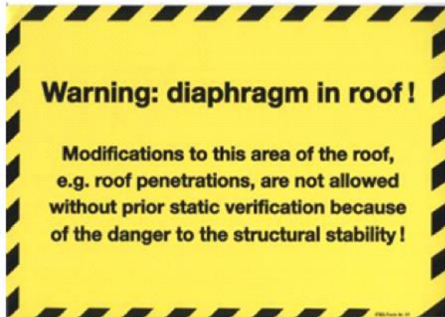
Рисунок 7 – Приклад попереджувального знака «Обережно! В покрівлі діафрагма»
