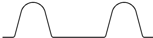
Рисунок 3 – Частина типового трапецієвидного профілю з заокругленими гребенями Figure 3 – Part of typical trapezoidal profile with rounded crowns
