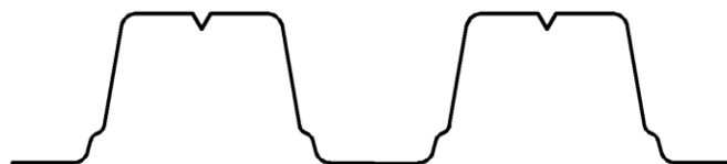
Рисунок 4 – Частина типового трапецієвидного профілю з підсиленими гребенем і стінкою Figure 4 – Part of typical trapezoidal profile with stiffened crown and web
