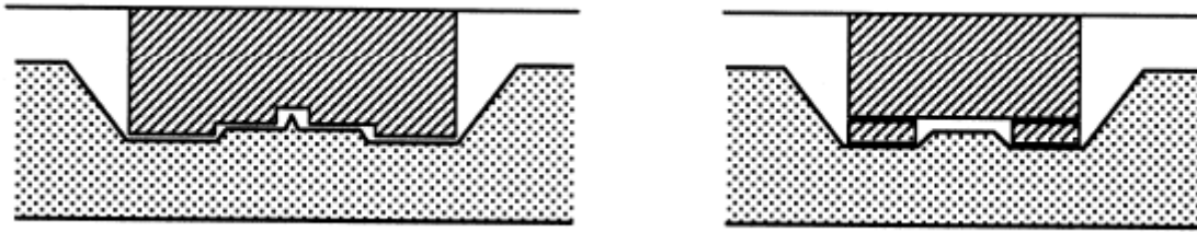
Рисунок А.12 – Навантажувальні пластини для облицювань з ребрами жорсткості ( Figure A.12 – Loading platens for facings with stiffeners)
