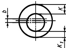
3.8. Для испытания на вязкость стопорную шайбу зажимают в тисках, лапки двукратно загибают и отгибают на угол 90°.
