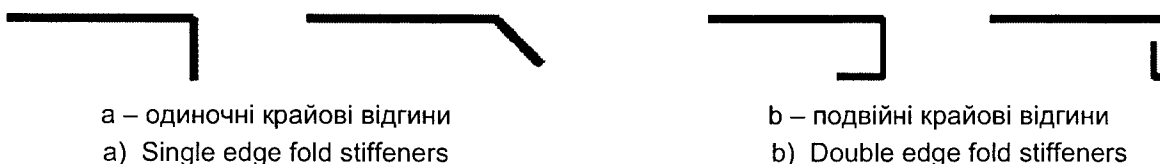
Рисунок 1.4 – Типові крайові елементи жорсткості
