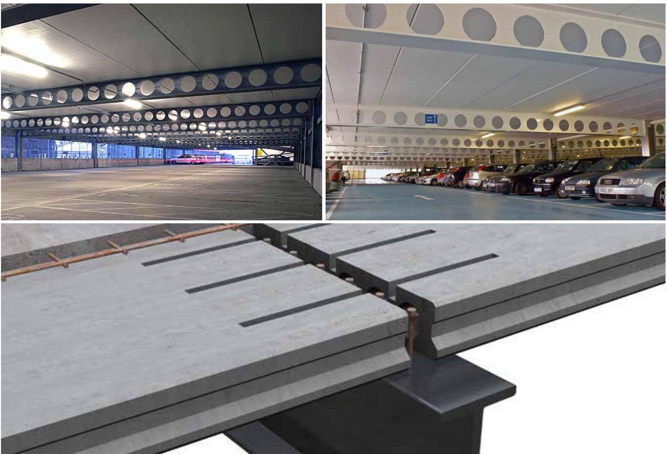
Рис. 3.4. Загальна схема і приклад реалізації рішення з композитних збірними ж-б плитами перекриття по сталевих балках.
