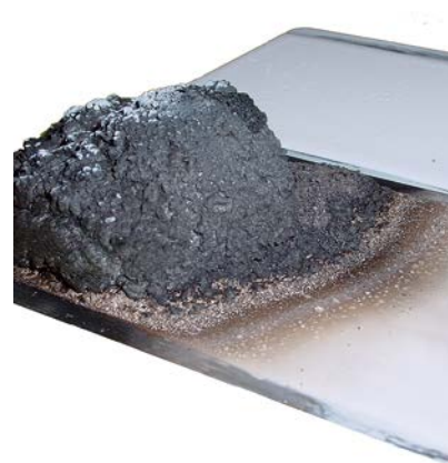
Рисунок 171. Применение плит для огнезащиты основных несущих конструкций при тепловом воздействии
