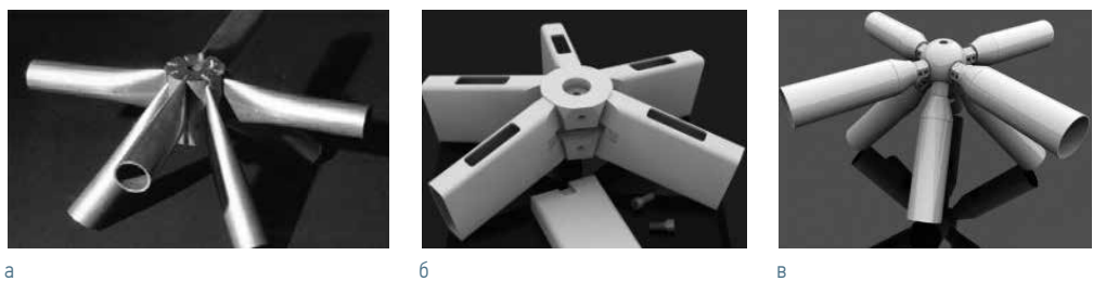
Рисунок 122. Типы соединений структурных пространственных систем: 1 – болтовое с плоскими трубами и накладкой на сквозной шпильке (условно не показана); 2 – болтовое с закручиванием через окна; 3 – комбинированное с болтовым примыканием в выточенный элемент
