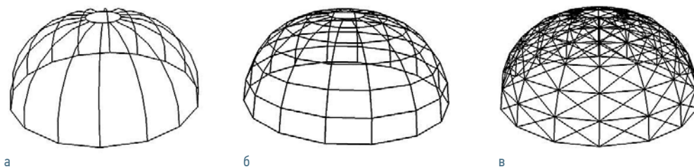
Рисунок 99. Конструктивная система куполов: а – ребристые; б – ребристо-кольцевые; в – сетчатые
