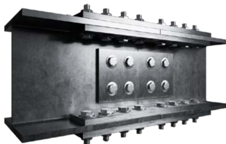
Рисунок 128. Монтажные стыки балок с накладками и фрикционными соединениями на высокопрочных болтах
