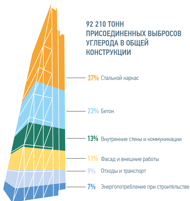
Рисунок 166. Структура присоединенных выбросов углерода в системе здания Leadenhall высотой 225 м, Лондон, Англия, архитектурное бюро Rogers Stirk Harbour + Partners, конструктивный проект бюро Arup, 2014 год
