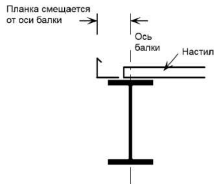
Рисунок 8.15. Расположение планки относительно оси балки
