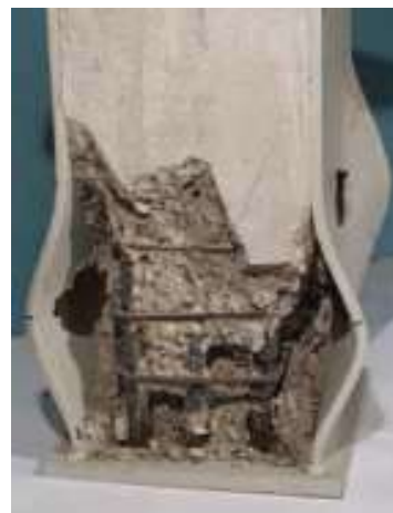
Рисунок 5.58. Примеры местной потери устойчивости стальных профилей в составе сталежелезобетонных колонн
