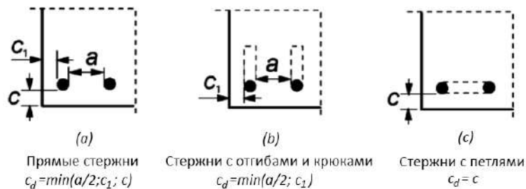
Рисунок 8.37. К определению c_d для балок и плит
