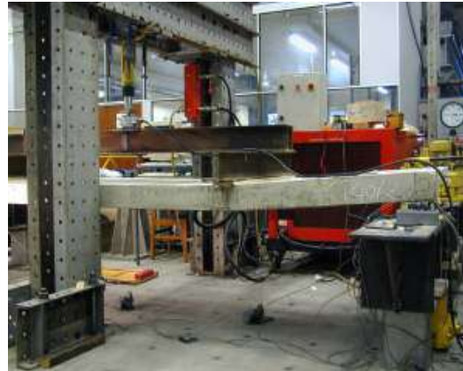
Рисунок 5.14. Схема и пример испытательного стенда для сталежелезобетонной плиты
