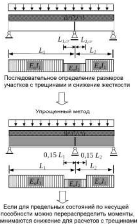
Рисунок 4.11. Учет трещинообразования в неразрезных балках для расчетов несущей способности и эксплуатационной пригодности
