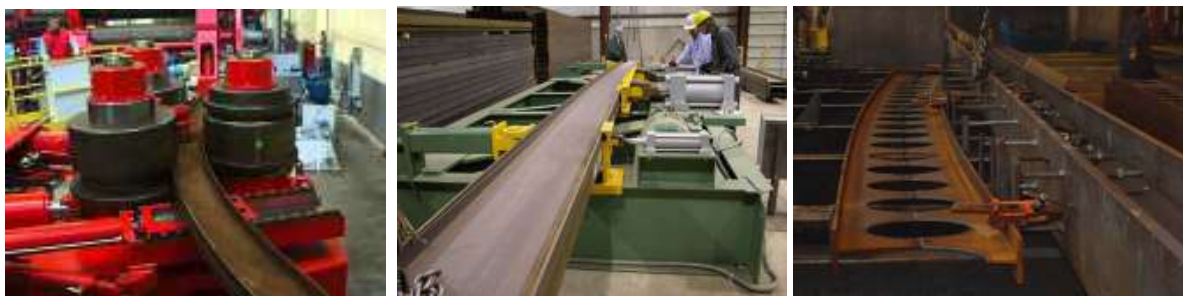
Рисунок 8.23. Примеры задания строительного подъема балкам
