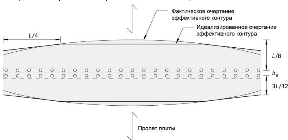
Рисунок 5.22. К определению эффективной ширины полки сталежелезобетонной балки
