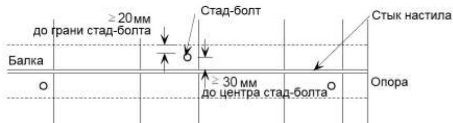
г) Стык настила (правильное расположение одиночных стад-болтов)
