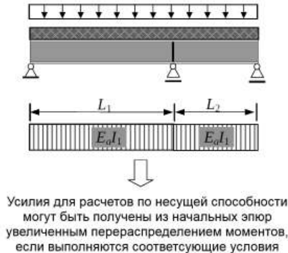
Рисунок 4.12. Альтернативный метод учета трещинообразования в неразрезных балках для расчетов несущей способности с перераспределением усилий
