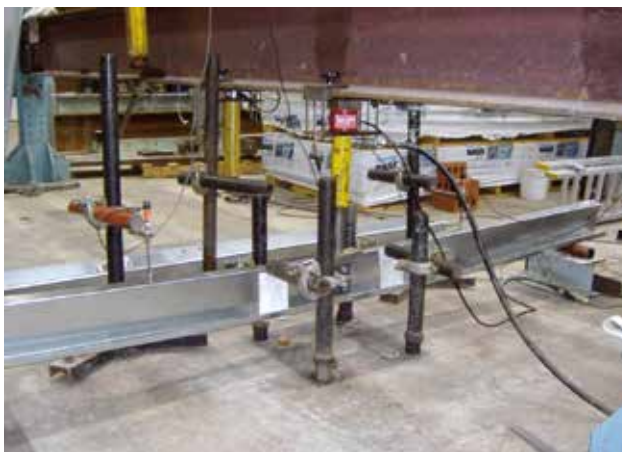
Рисунок 1.2 Испытание образца тонкостенного прогона покрытия
