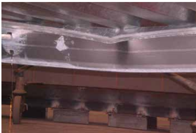
Рисунок 6.1 Потеря несущей способности тонкостенного стального прогона покрытия при изгибе
