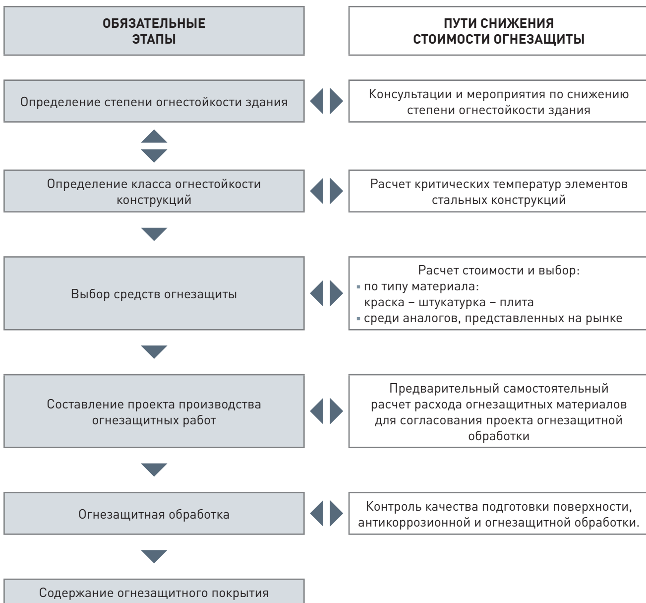
Рис. 9 – Основные этапы огнезащитной обработки
