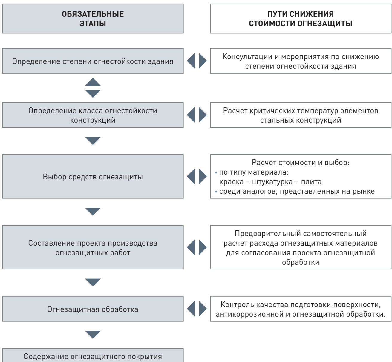
Рис. 9 – Основные этапы огнезащитной обработки
