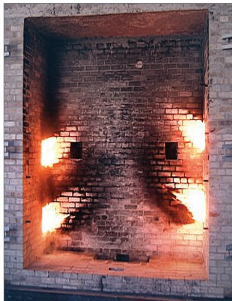
Огнезащитное покрытие разной толщины наносится на образцы стальных колонн и балок. В процессе огневых испытаний определяется время достижения на образцах критической температуры или возникновения критических деформаций.
