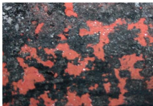
*Адгезия коксового слоя интумесцентного покрытия, нанесенного на разные грунты, после воздействия пламени*
