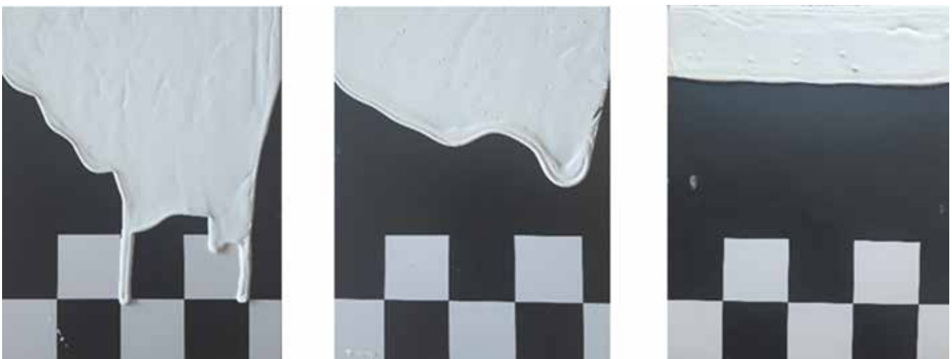
Рисунок 5.6. Візуалізація експериментальних дослідів з перевірки провисання інтумесцентних вогнезахисних фарб
