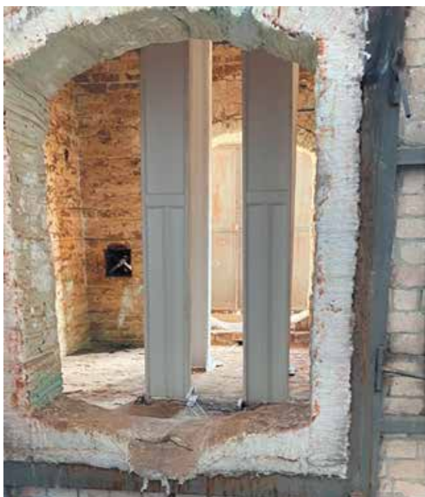
Вогневі випробування сталевих колон з реактивним покривом Ammokote MW-120
