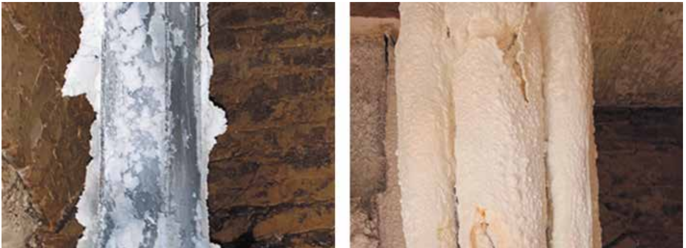
Рисунок 5.2. Приклади поведінки реактивного покриття при проведенні вогневих випробувань на ґрунтовках різного типу: а) несумісна стиролакрилова ґрунтовка; б) сумісна алкідна ґрунтовка
