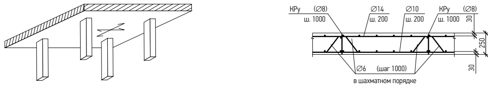
Рисунок 5.7 Принятая схема и поперечное сечение безбалочного железобетонного перекрытия, работающего в двух направлениях
