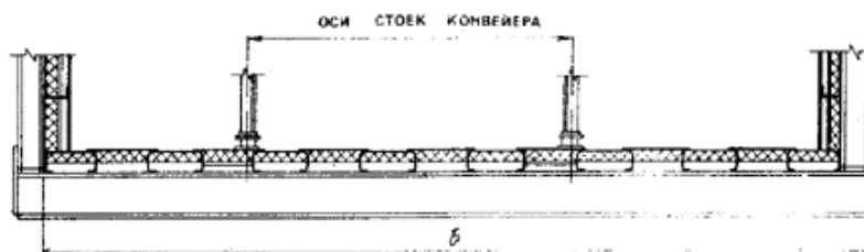
Рис. 45. Поперечное сечение перекрытия с металлическим настилом
