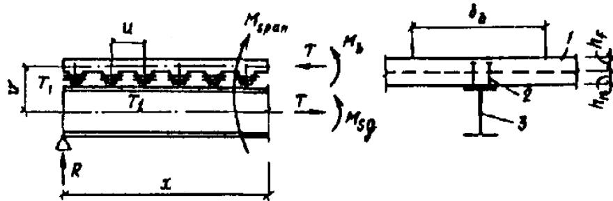
Рис. 17. Схема усилий в комбинированной балке
