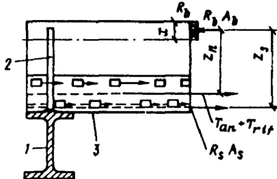
Рис. 14. Схема усилий при расчете по прочности анкеровки
