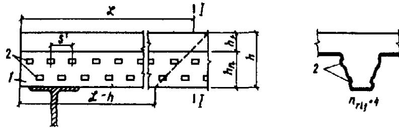
Рис. 16. Расположение рифов на стенках СПН по его концам
