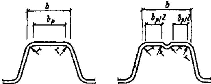
Рис. 5. К определению ширины плоских участков сжатых полок
