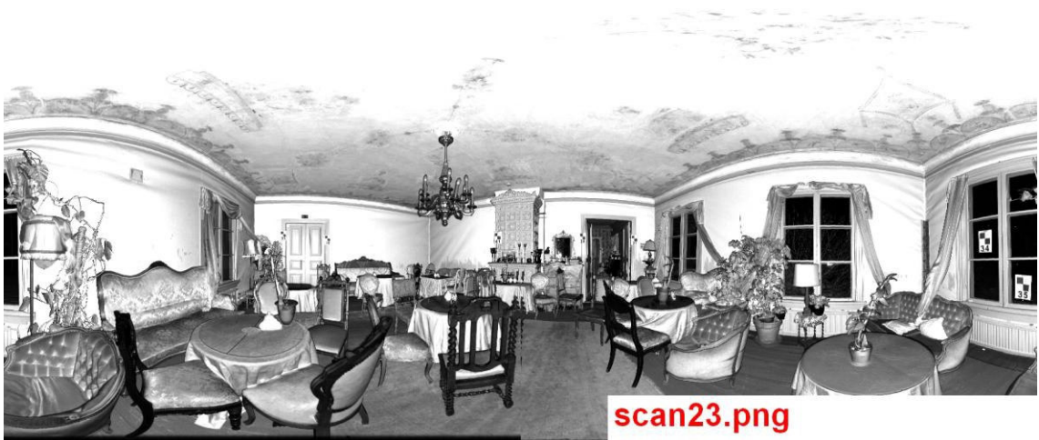
Тривимірне зображення з лазерного сканування, кафе Таммініємі, місто Гельсінкі, рисунок від: Tietoa Finland Oy.
