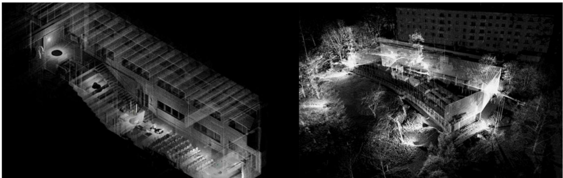
Ліворуч — модель хмари точок лазерного сканування для внутрішніх вимірювань, а праворуч — для зовнішніх вимірювань, рисунок від: Tietoa Finland Oy
