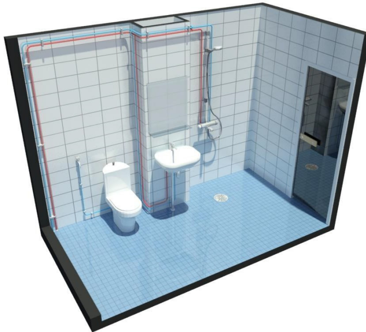
Рисунок 3.5.2: Візуалізація системи трубопроводів у вбиральні
