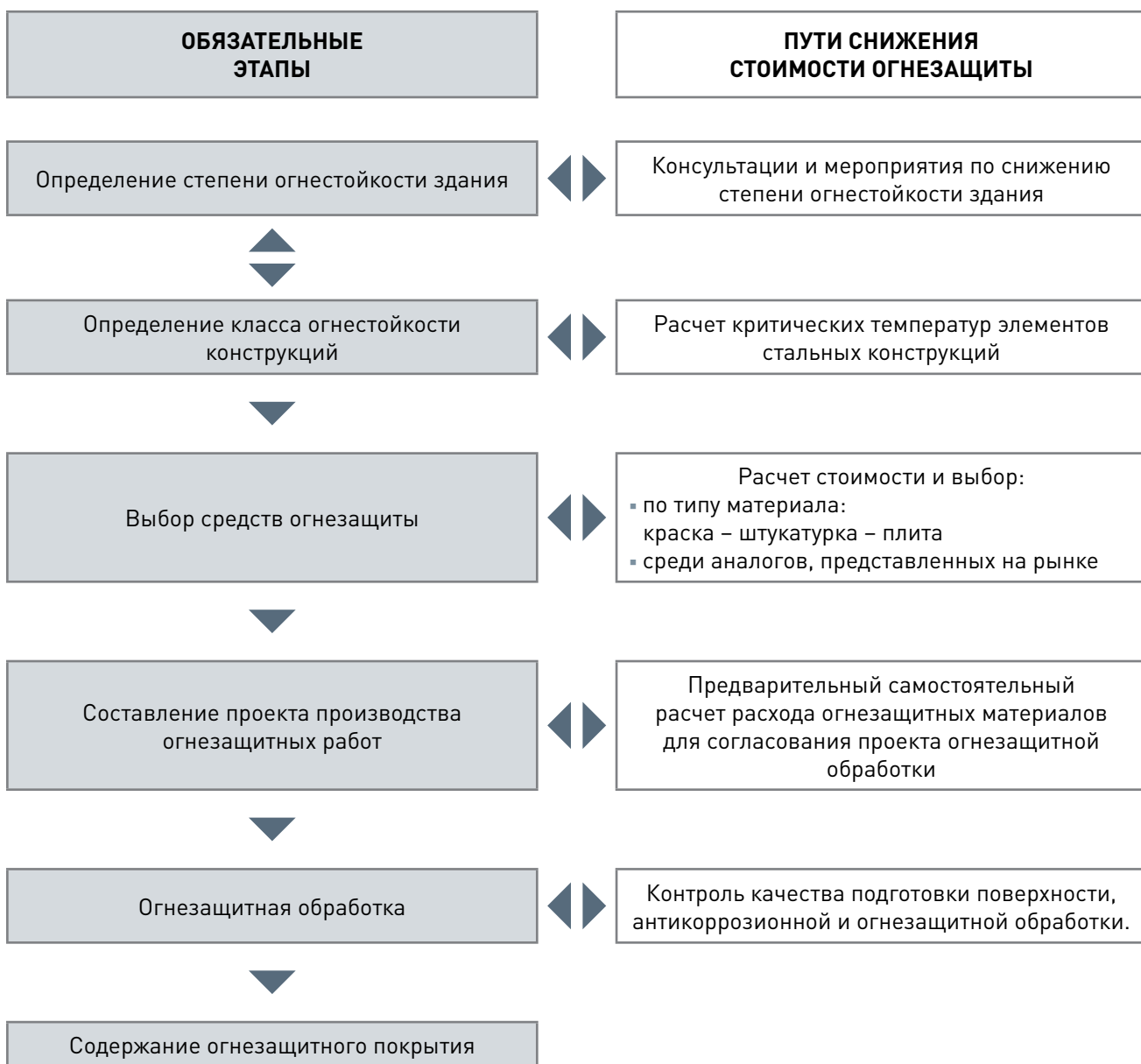
Рис. 9 – Основные этапы огнезащитной обработки
