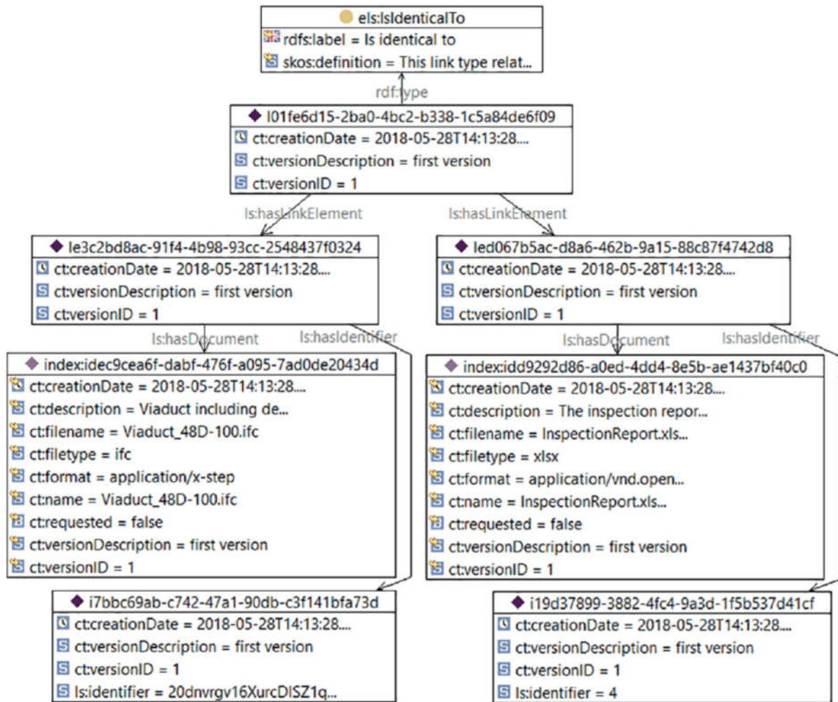
Рисунок А.6 – Приклад 3: структура контейнера з доставленою інформацією
