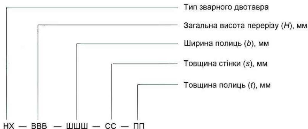
Рисунок А.1 — Схема умовного позначення двотаврів сталевих зварних
