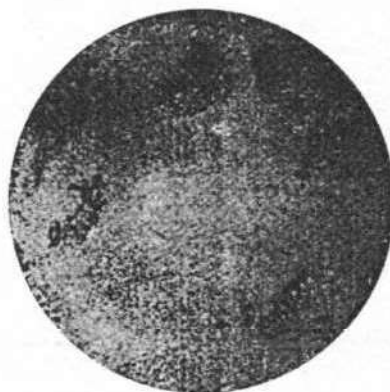
Рисунок Г.23 — Різнозернистість та різна травленість у разі наклепу металу
