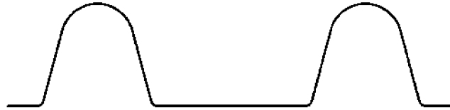
Рисунок 3 – Частина типового трапецієподібного профілю з заокругленими гребенями
