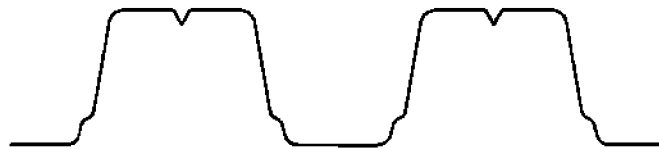
Рисунок 4 – Частина типового трапецієподібного профілю з підсиленими гребенем і стінкою
