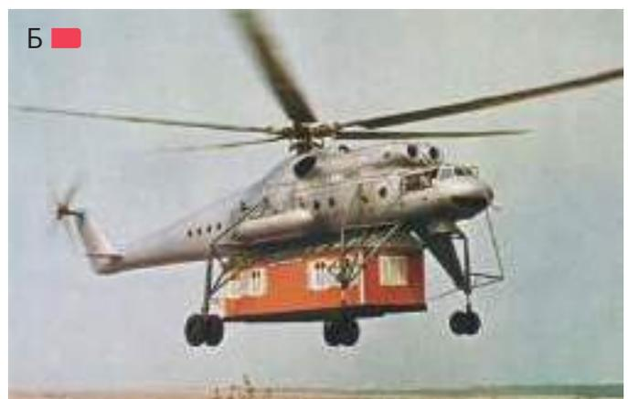
**Рис. 5.2.6** – Перемещение малогабаритных облегченных зданий с помощью вертолетов: А – Sikorsky S-58; Б – Ми-10
