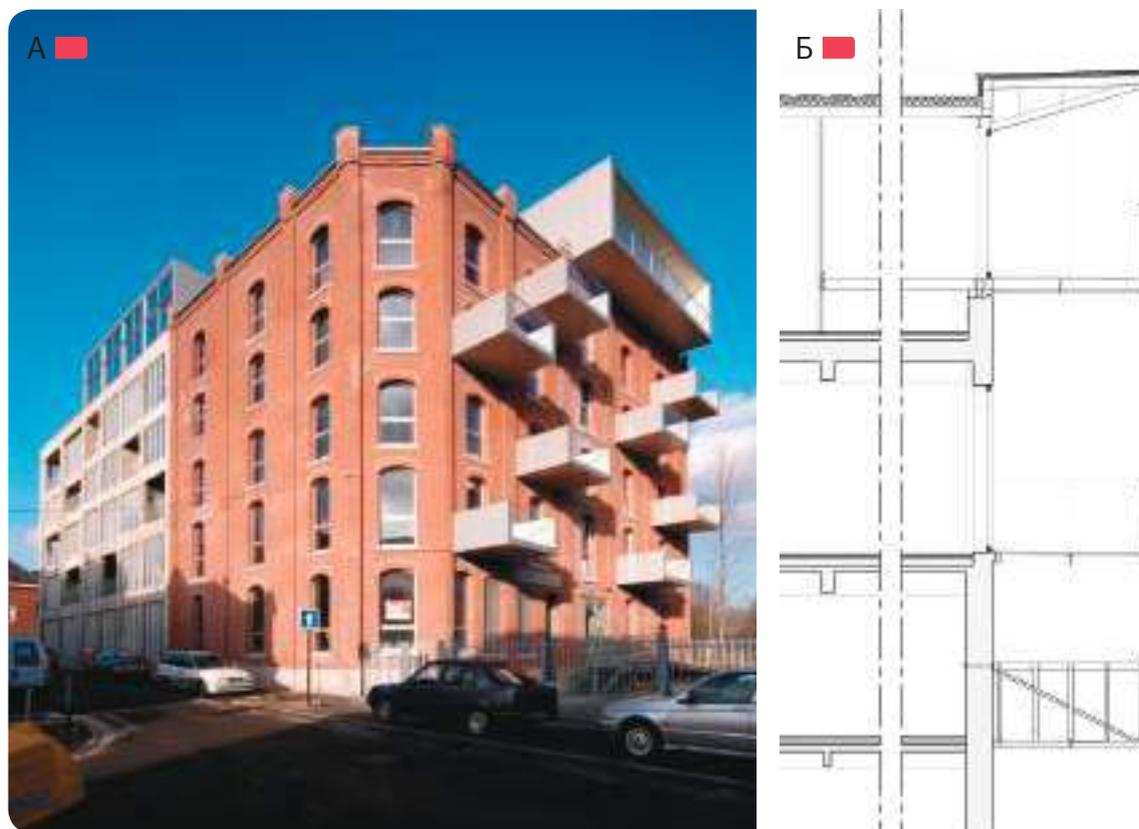
**Рис. 4.1.3** – Реконструкция здания La Minoterie во Франции с образованием балконов при помощи плит, балок и подвесов, проект бюро Tank Architectes, 2008 г.
