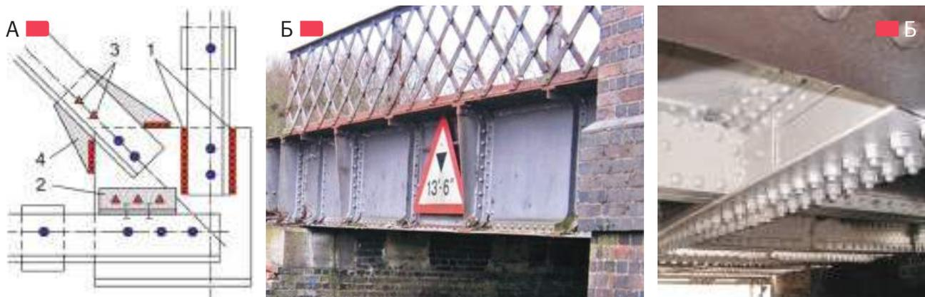
**Рис. 2.5.6** – Схема усиления узла фермы на заклепках: А: 1 – дополнительные швы; 2 – накладки из уголков; 3 – фрикционные болты; 4 – расширение фасонки; Б – усиление балок моста Broadway bridge США посредством установки накладок на фрикционных высокопрочных болтах
