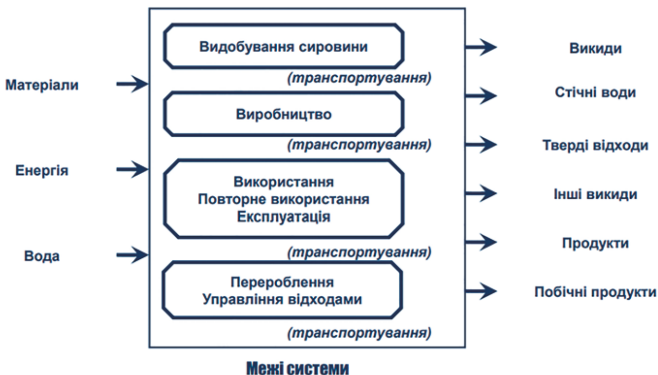
Рис. 1.28. Застосування LCA для будівлі, входи та виходи як для системи
