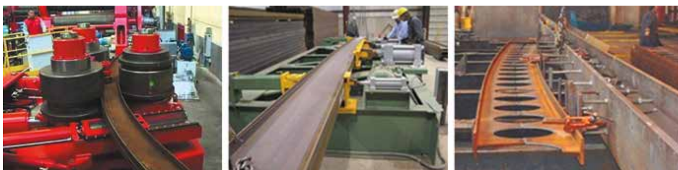
Рис.6.9. Приклади надання балкам будівельного підйому (пояснення див. у тексті).
