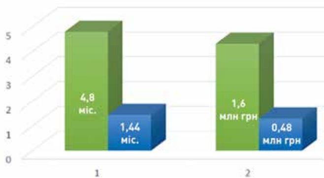
Рис. 3.9. Економічний ефект від застосування BIM для об'єкту площею 200 тис. м 2 . 1 – існуючий метод; 2 – метод із застосуванням автоматизованих перевірок колізій у BIM, таблиця порівняння [3.31]
