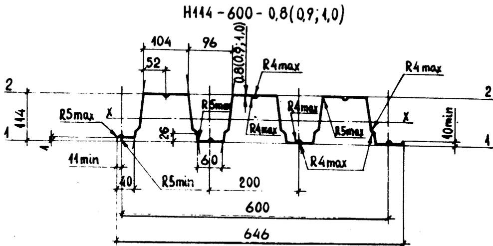
Рис.2. Размеры поперечных сечений профилей с высотой гофров 75 и 114 мм
