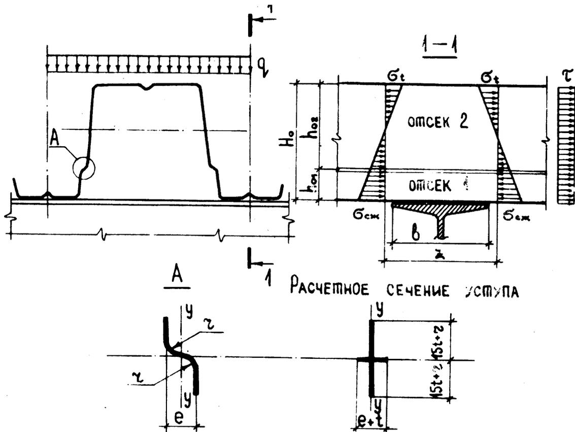
Рис.4. Расчетная схема гофра со стенками ступенчатой формы
