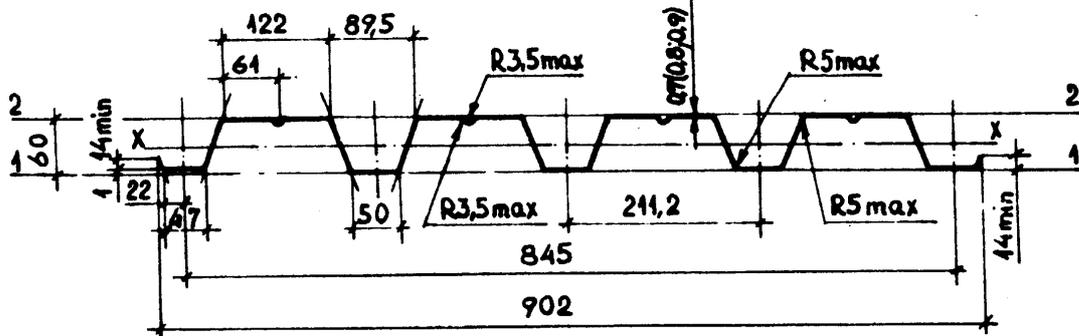
Рис. I. Размеры поперечных сечений профилей с высотой гофров от 40 до 60 мм.
