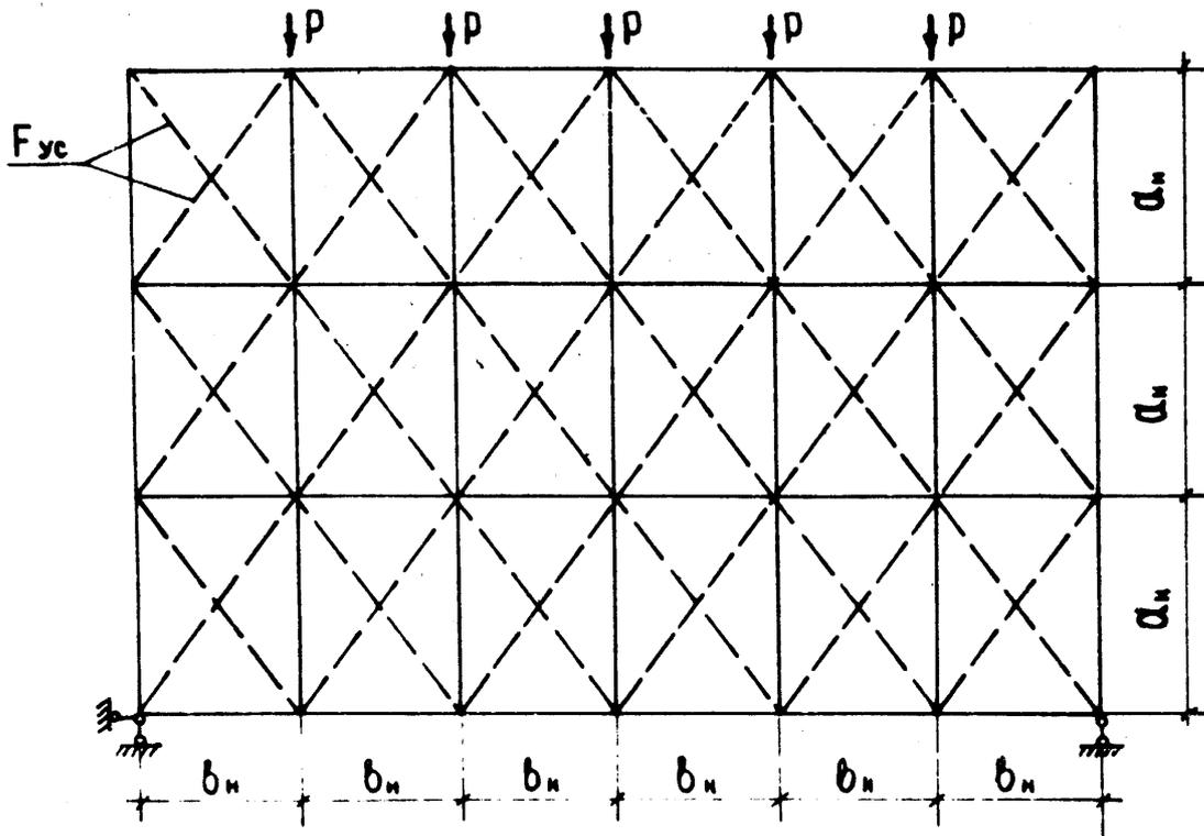
Рис.5. Расчетная схема диска из профилированного настила
