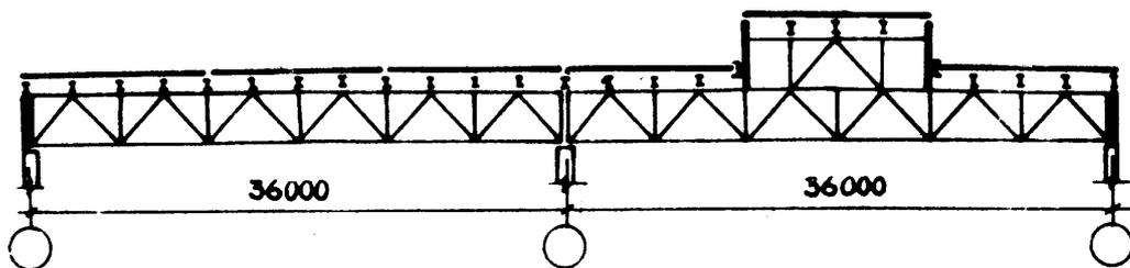
Рис. 3. Схемы раскладки настилов в покрытиях зданий
