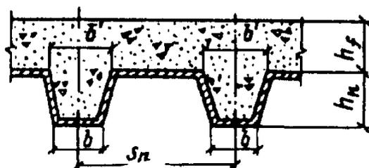
Рис. 4. К определению приведенной толщины бетона
