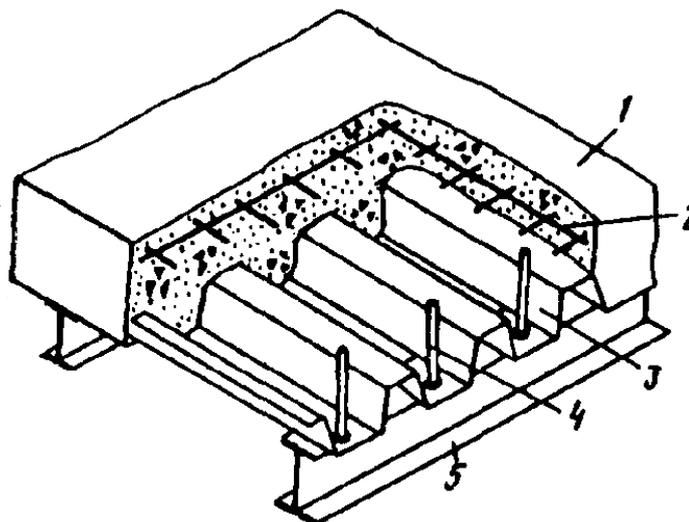
Рис. 3. Конструкция монолитного перекрытия по СПН с вертикальными стержневыми анкерами
