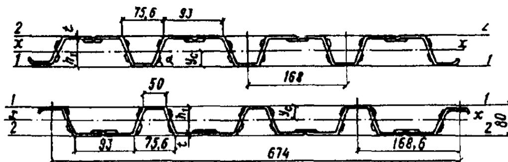
Рис. 1. Стальной профилированный настил, рекомендуемый для монолитных перекрытий
