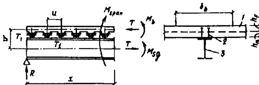
Рис. 17. Схема усилий в комбинированной балке
