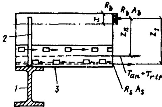
Рис. 14. Схема усилий при расчете по прочности анкерования
