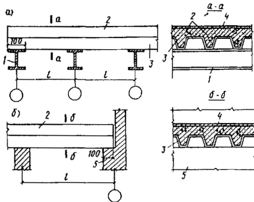
Рис. 2. Конструктивные схемы монолитного перекрытия по СПН
