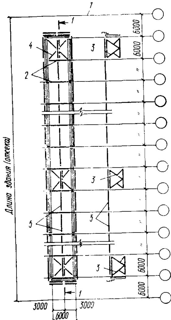
Рис. 22. Схема расположения связей по фонарю при шаге стропильных ферм 6 м
