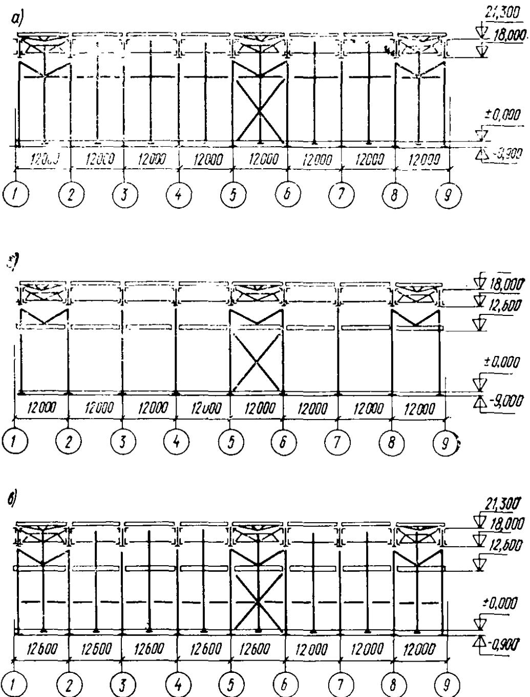
Рис. 43. Продольные разрезы здания
