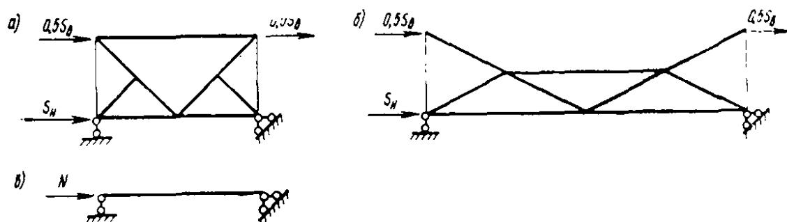
Рис. 17. Расчетные схемы вертикальных связей между опорными стойками стропильных ферм с шагом 8 м (а) и 12 м (б) и распорок (в) покрытий из стального профилированного настила
