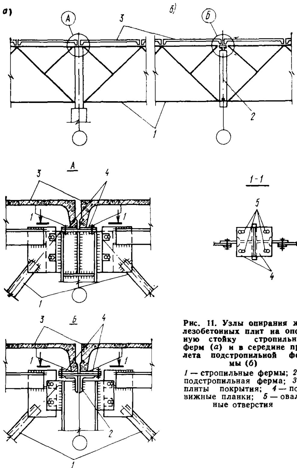
Рис. 11. Узлы опирания железобетонных плит на опорную стойку стропильных ферм (а) и в середине пролета подстропильной фермы (б)
