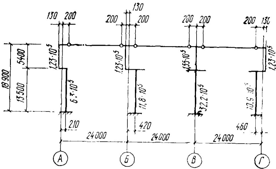
Рис. 44. Расчетная геометрическая схема поперечной рамы
