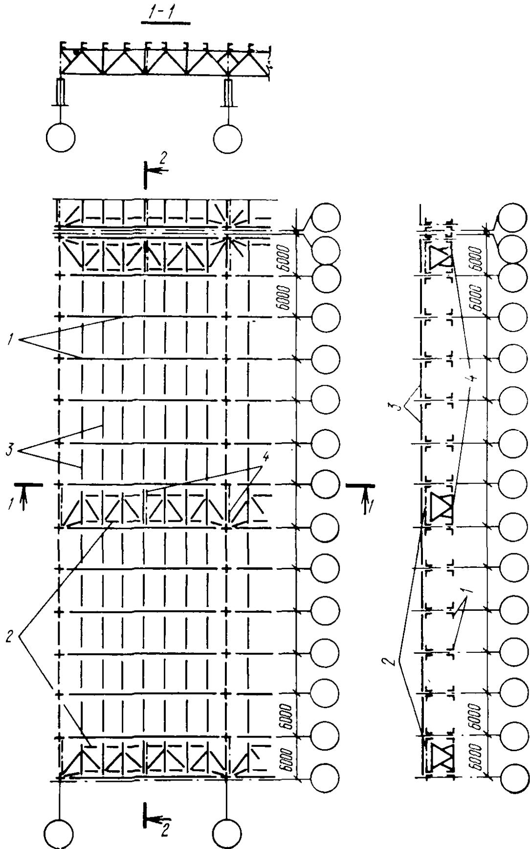
**Рис. 8. Пример расположения связей по верхним поясам стропильных ферм покрытия с прогонным решением кровли**
