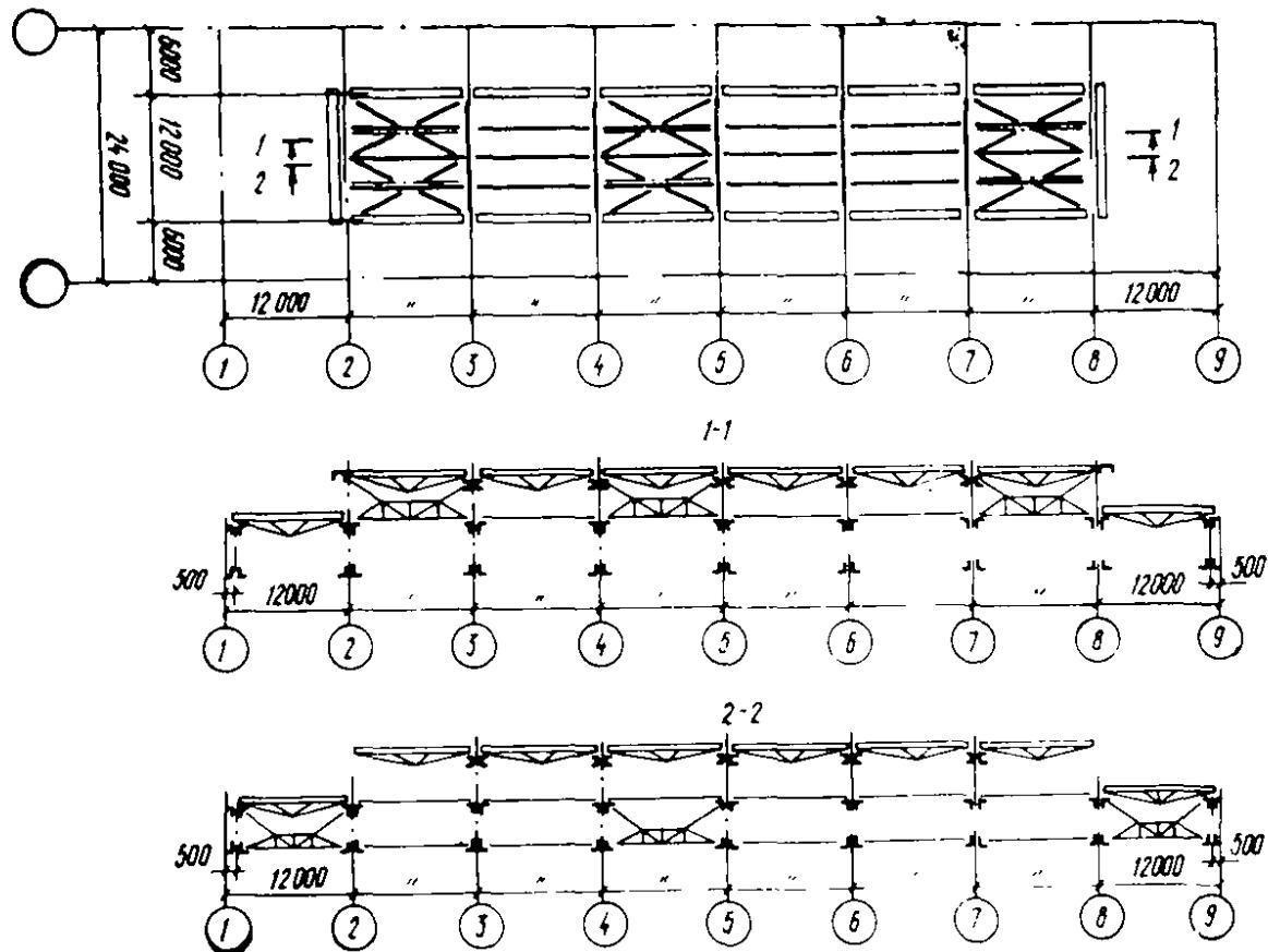
Рис. 54. План и разрезы по фонарю
