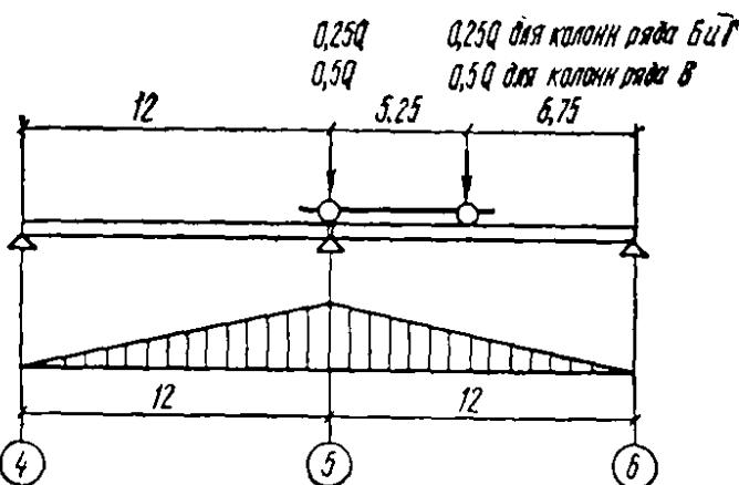
Рис. 46. Схема крановой нагрузки и линия влияния давления
