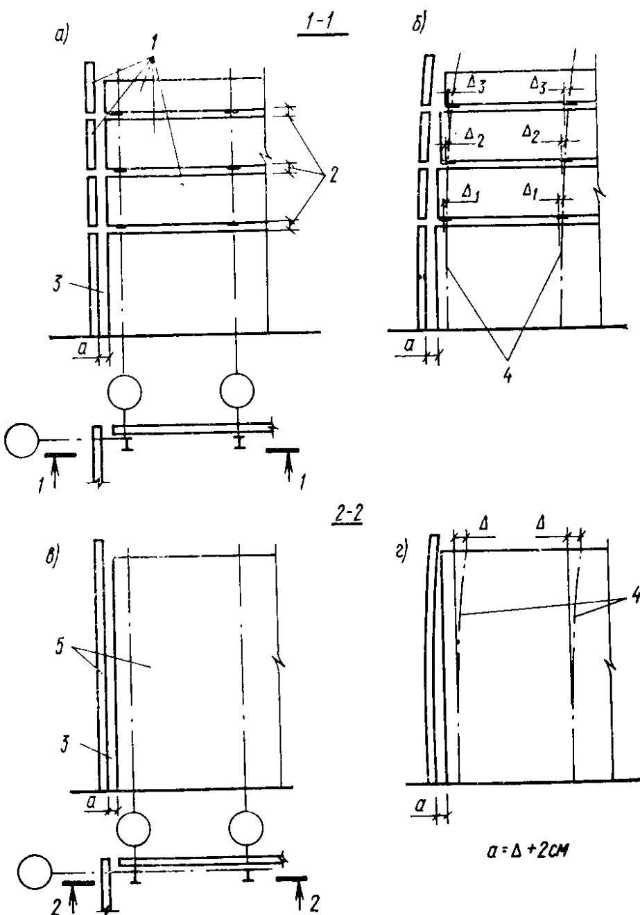
**Рис. 31. Схемы стен и их деформации при сейсмическом воздействии**
