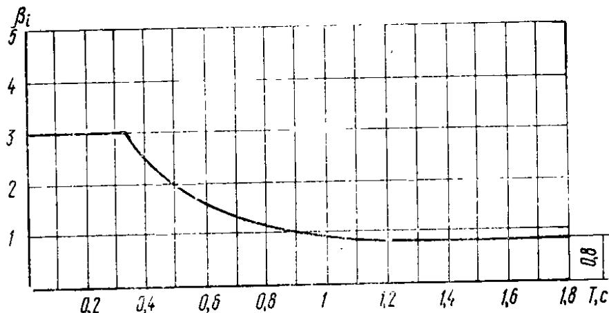
Рис. 2. Определение коэффициента динаминости  $\beta_i$
