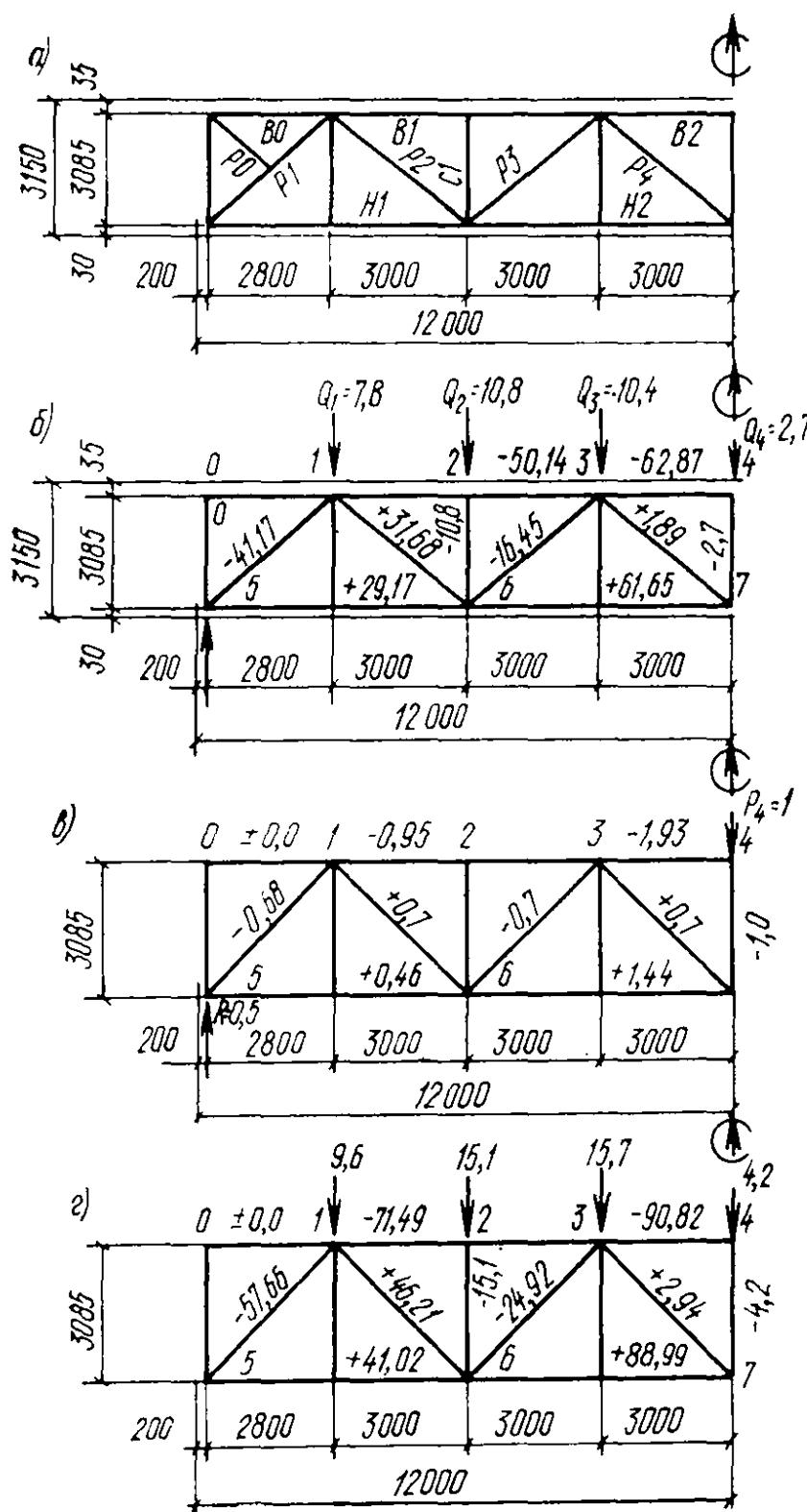
Рис. 57. Схемы к расчету стропильной фермы с учетом вертикальной сейсмической нагрузки
