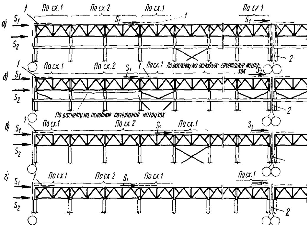
Рис. 19. Расположение расчетных схем подстропильных ферм по длине зданий (отсеков) с покрытиями из стального профилированного настила
