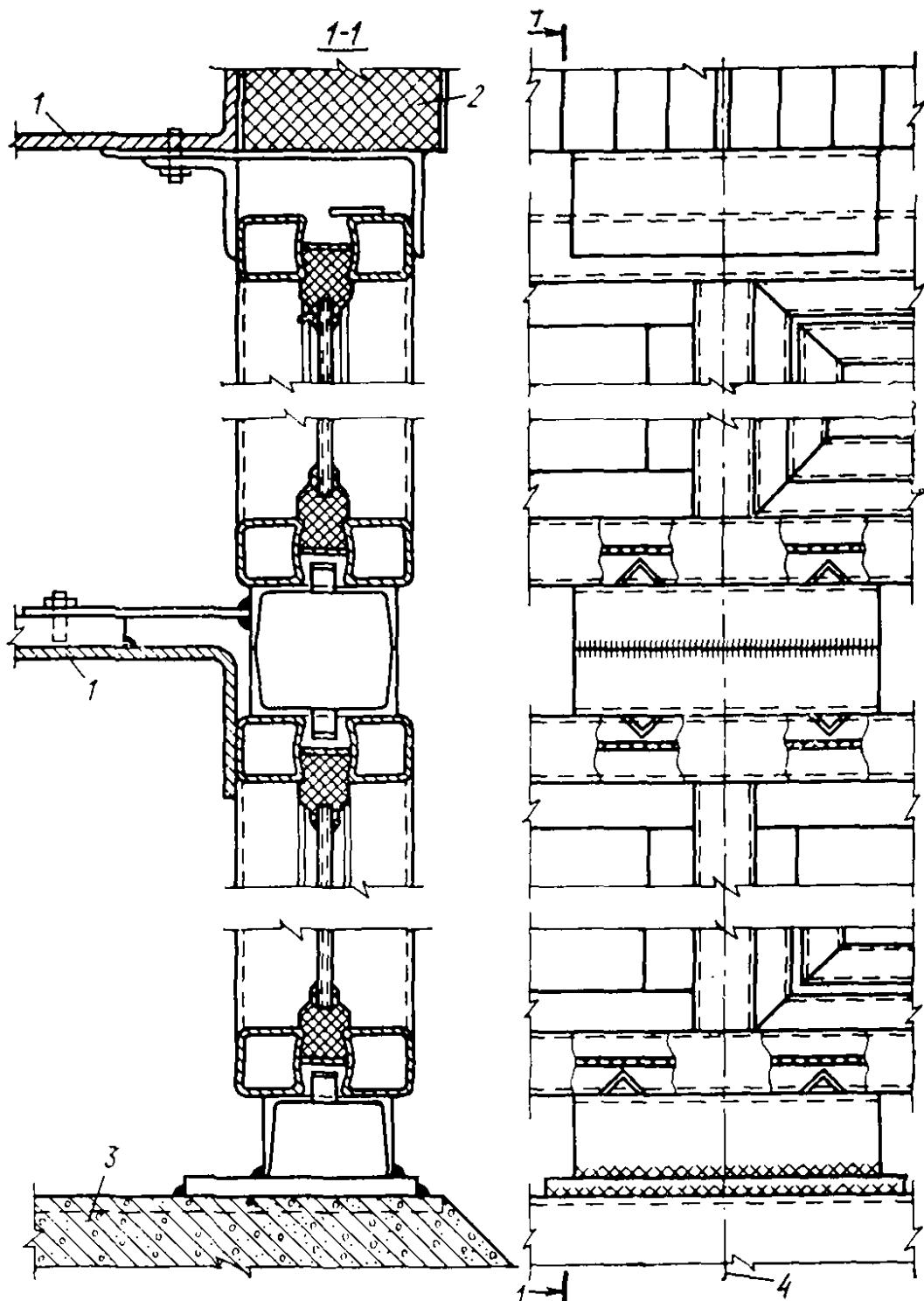
**Рис. 34. Пример крепления окон из спаренных тонкостенных труб к цокольной панели и ригелям стен**
