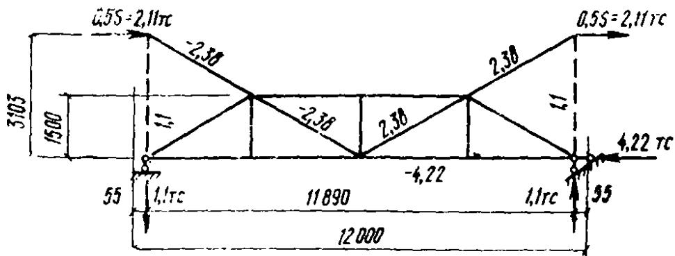
Рис. 56. Расчетная схема вертикальной связи по фонарю
