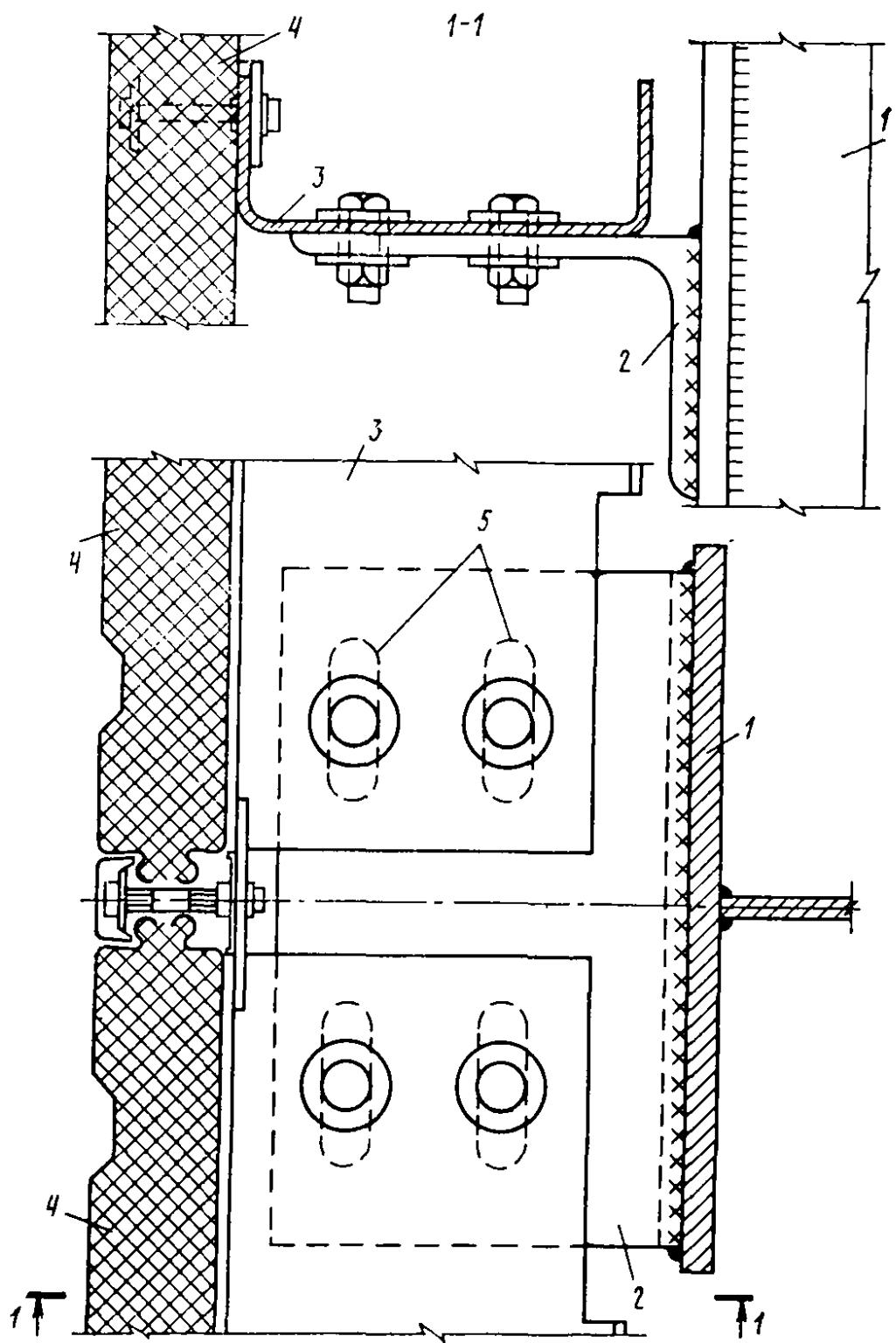
**Рис. 37. Пример крепления металлической стены из трехслойных панелей к колонне в уровне рядовых ригелей стены**
