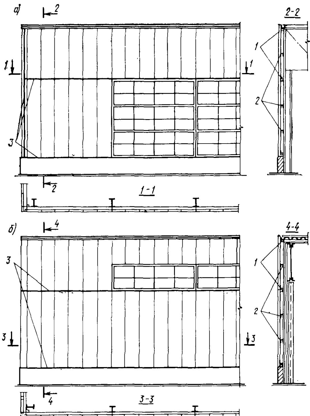
Рис. 35. Примеры решения металлических стен из трехслойных панелей
