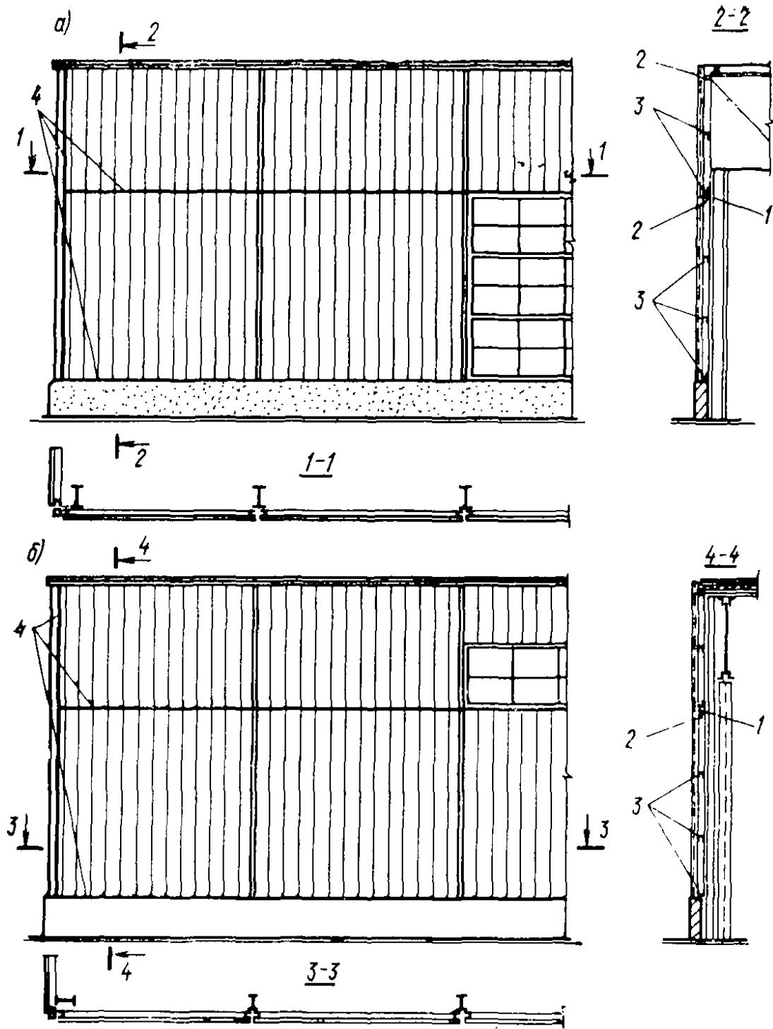
**Рис. 39. Примеры решения металлических стен из укрупненных монтажных панелей**
