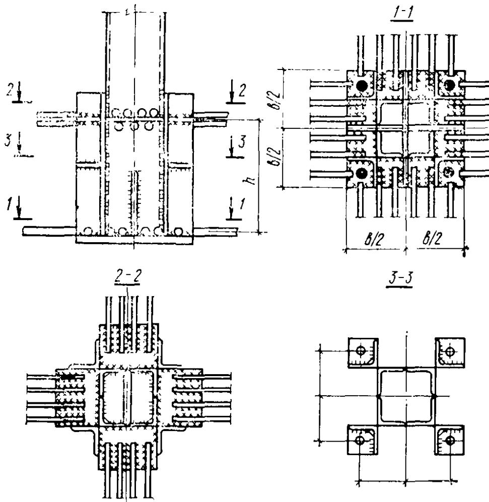
Рис. 28. Узел жесткого безбашмачного опирания колонны многоэтажного здания на фундамент
