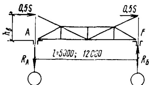
Рис. 24. Расчетная схема вертикальной связи между фонарными фермами
