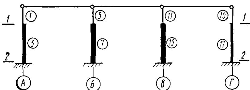
Рис. 49. Схема нумерации стержней рамы
