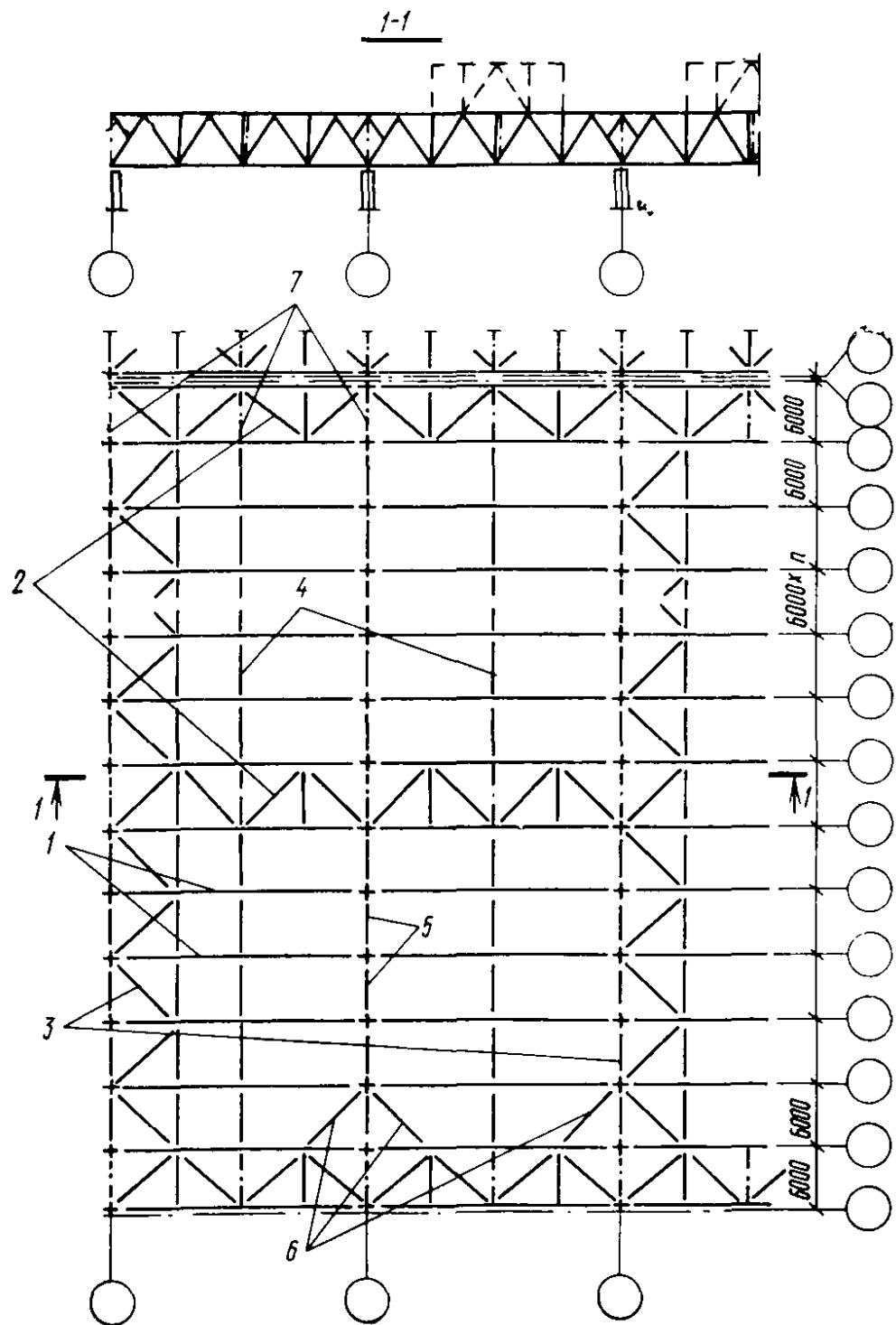
**Рис. 9. Пример расположения связей по нижним поясам стропильных ферм**
