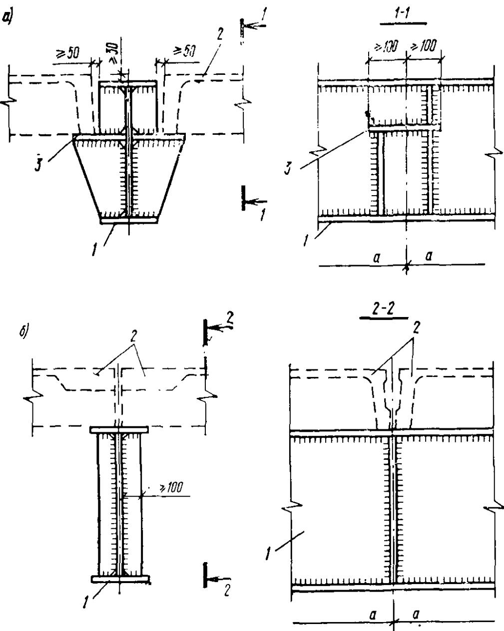
**Рис. 27. Узлы опирания железобетонных плит перекрытия на стальные ригели**
