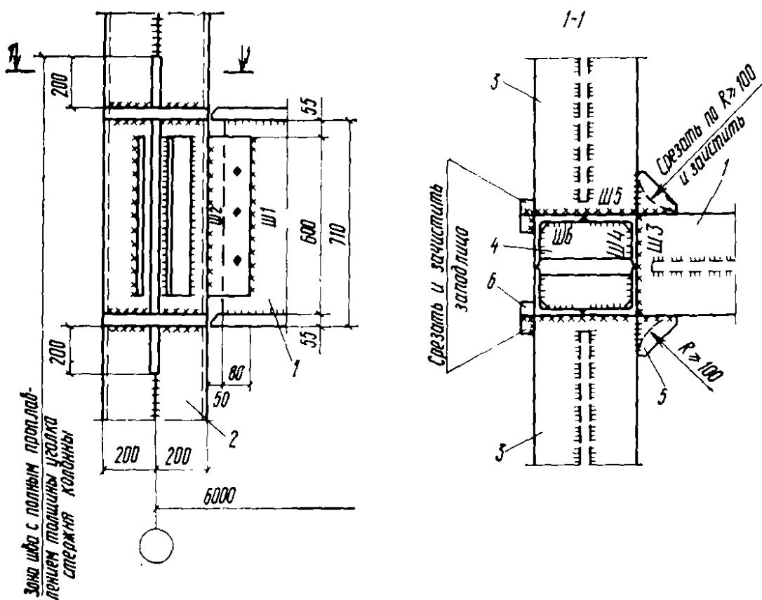
Рис. 58. Узел сопряжения ригеля с колонной многоэтажного здания
