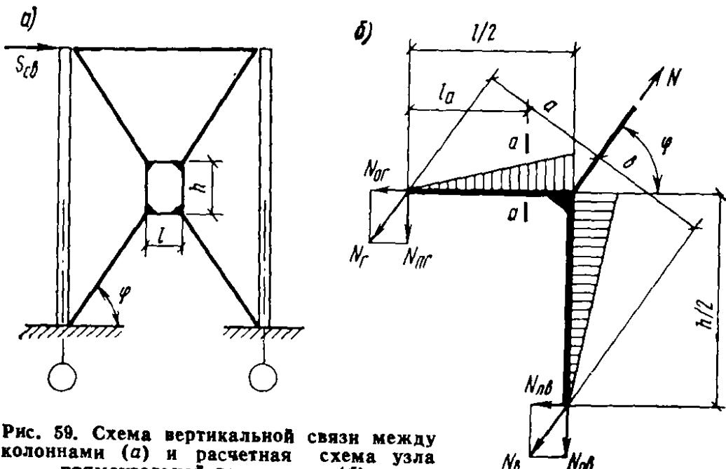
Рис. 59. Схема вертикальной связи между колоннами (а) и расчетная схема узла прямоугольной рамы связи (б)
