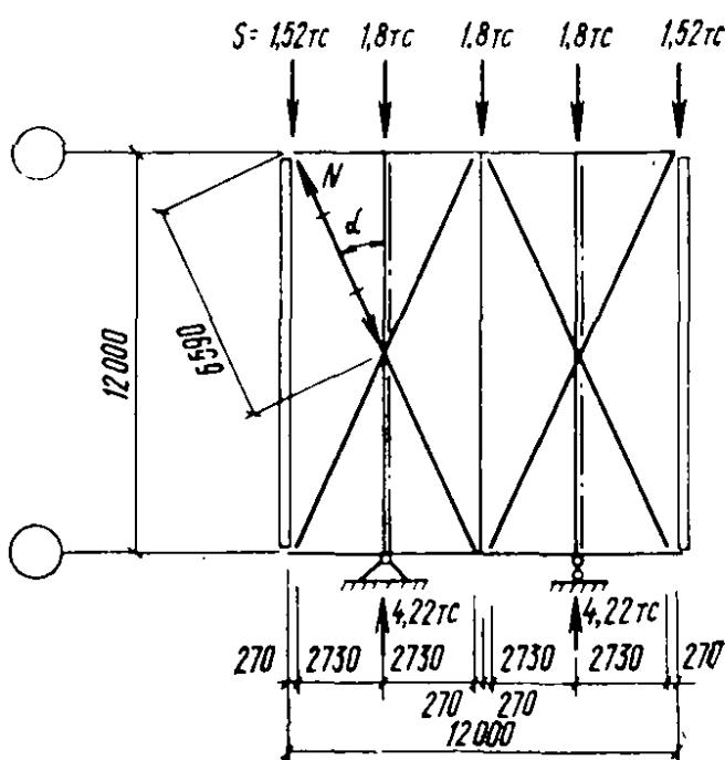
Рис. 55. Расчетная схема горизонтальной связи по фонарю
