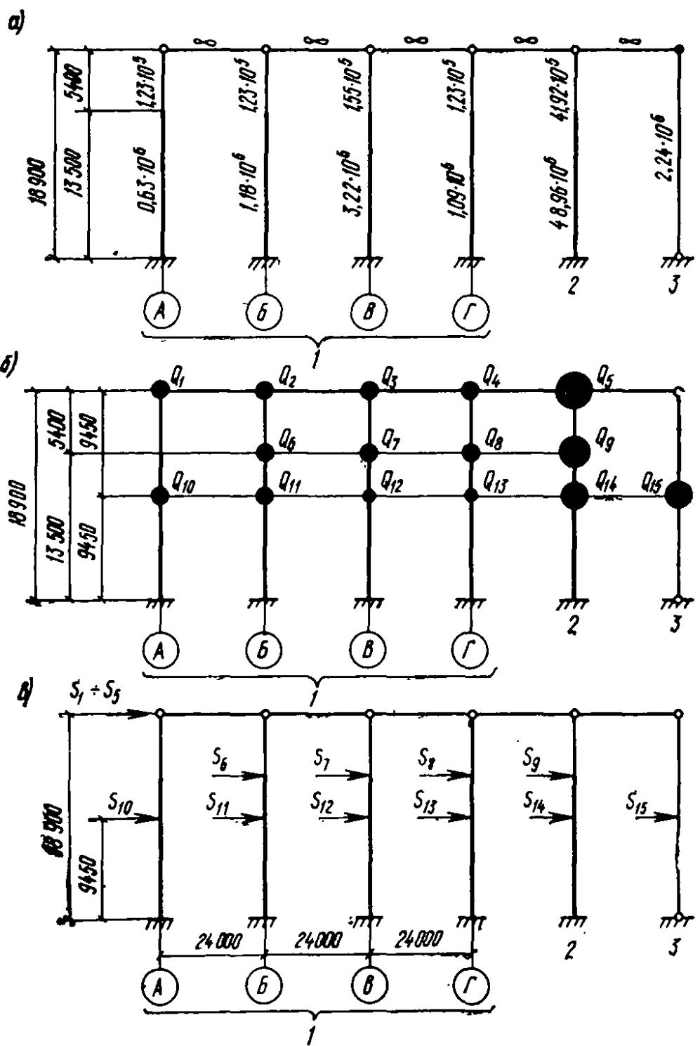
Рис. 48. Элементы со значениями моментов инерций (в  $\text{см}^4$ ), их сечений (а) и расположения вертикальных сосредоточенных нагрузок (б) в динамической расчетной схеме каркаса и расчетная схема каркаса (в)
