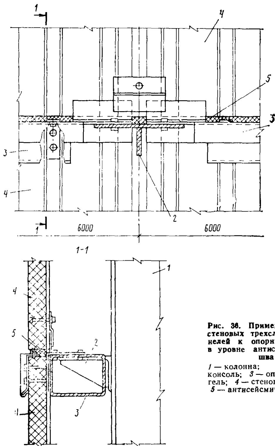
Рис. 36. Пример крепления
