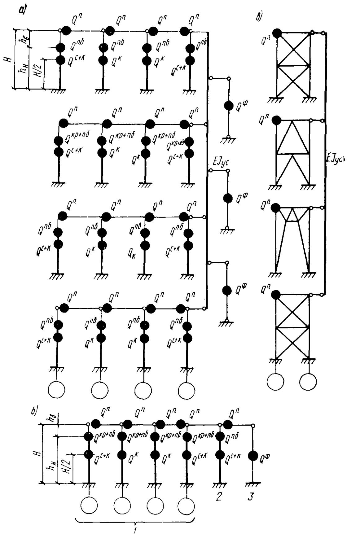
Рис. 3. Динамические расчетные схемы каркаса здания (отсека) при действии сейсмической нагрузки в поперечном (а, б) и продольном (в) направлениях
