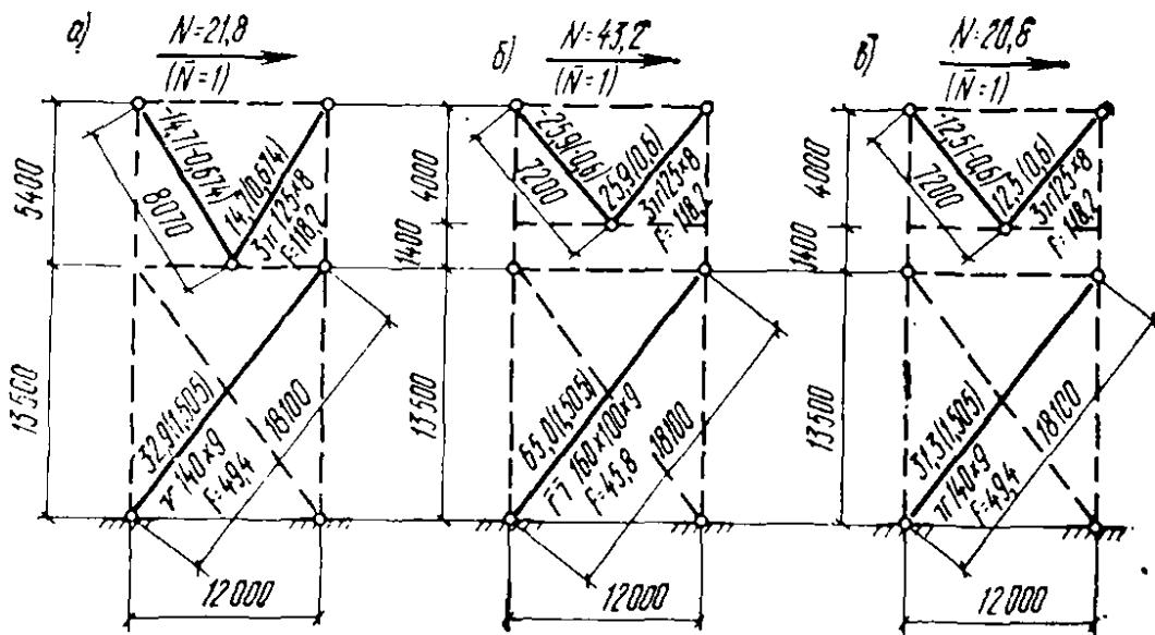
Рис. 45. Расчетные геометрические схемы связей по колоннам
