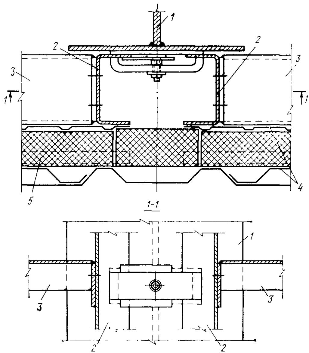
**Рис. 40. Пример крепления металлической стены из укрупненных монтажных панелей к колонне**
