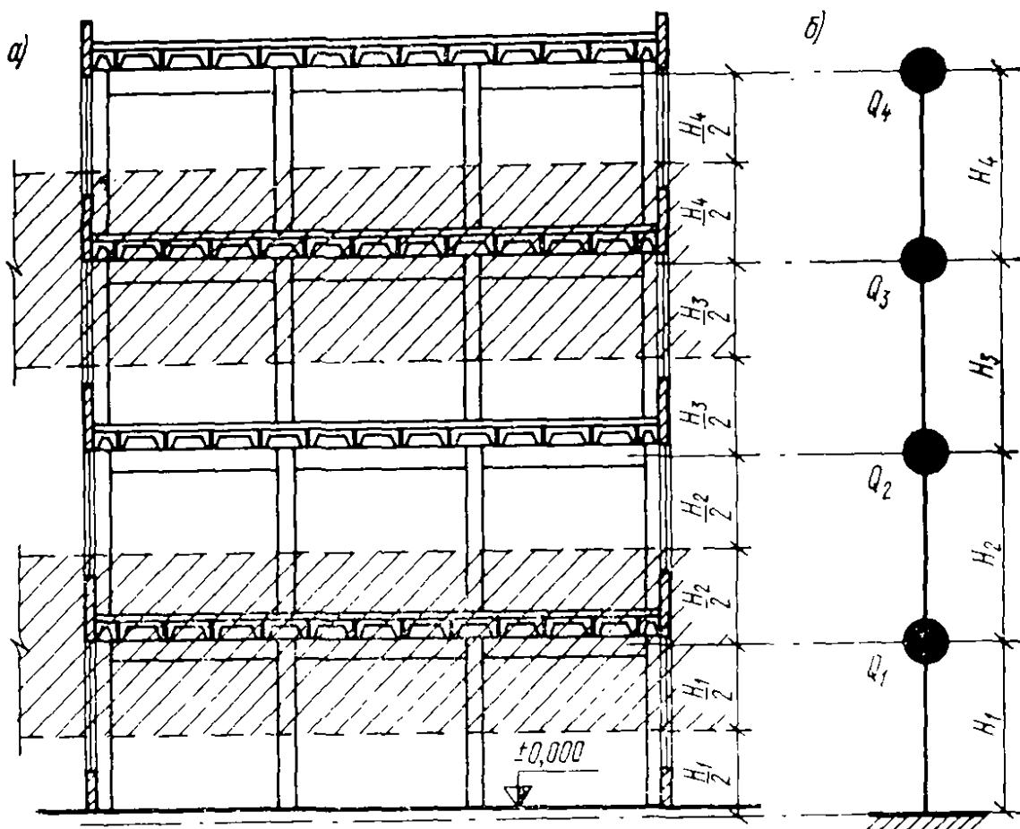
**Рис. 30. Динамическая расчетная схема каркаса многоэтажного здания**
