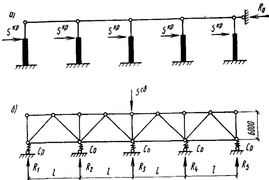
Рис. 15. Схемы к расчету продольных связей по нижним поясам стропильных ферм на сейсмическую нагрузку от мостовых кранов
