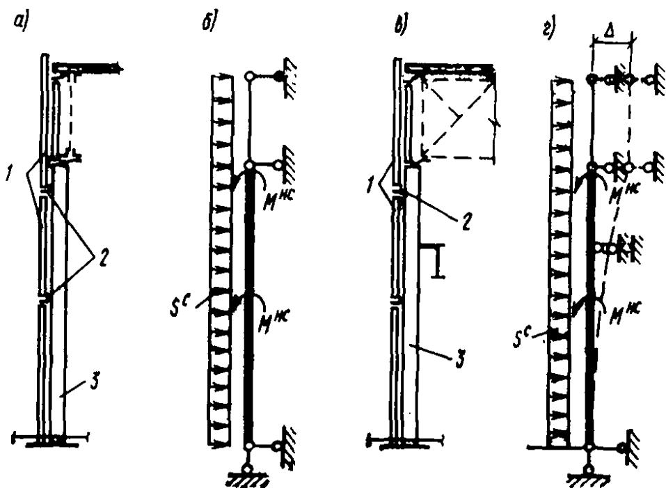
Рис. 6. Схемы к расчету фахверковых стоек зданий без мостовых кранов (а, б) и с мостовыми кранами (в, г)
