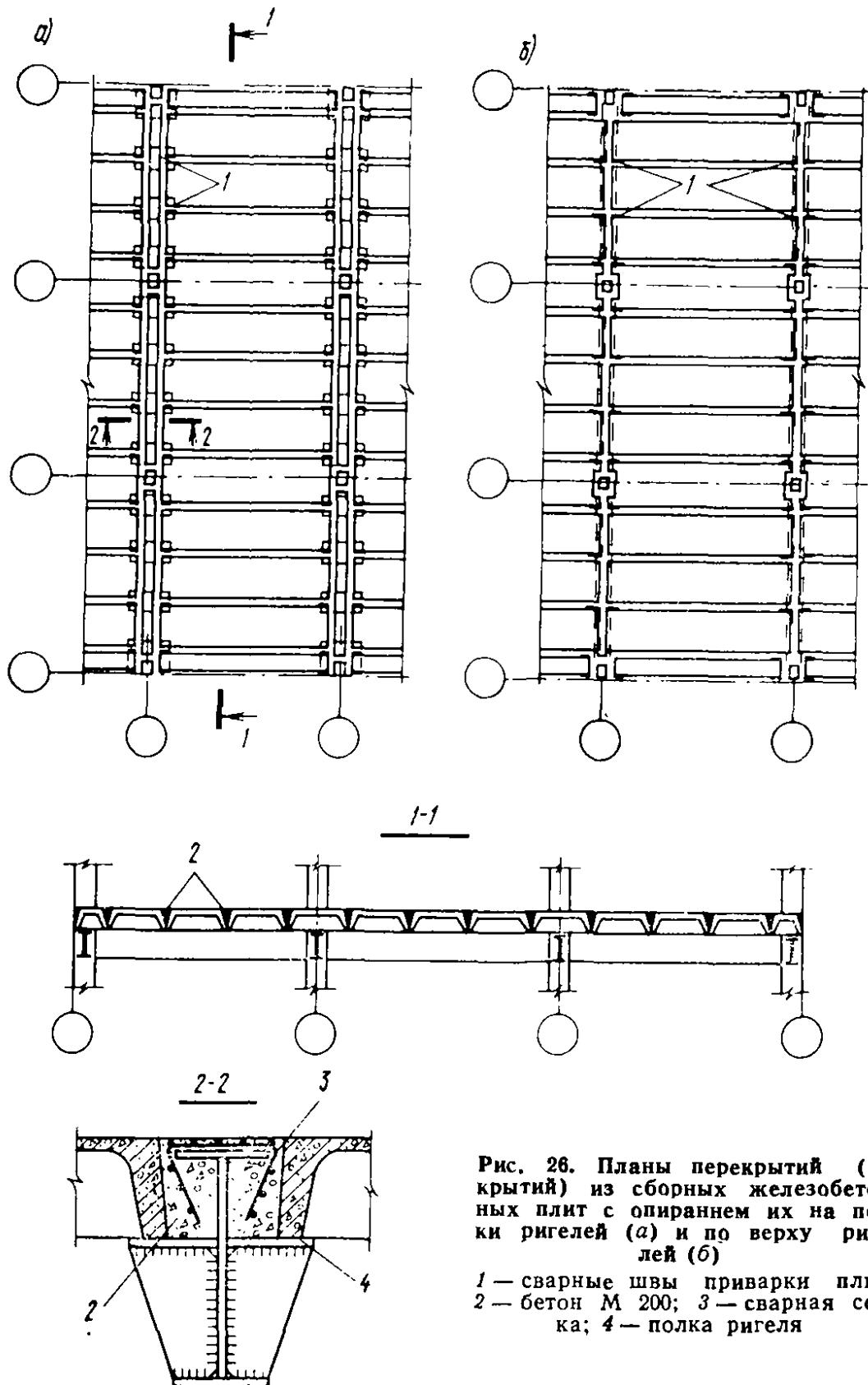
Рис. 26. Планы перекрытий (покрытий) из сборных железобетонных плит с опиранием их на полки ригелей (а) и по верху ригелей (б)
