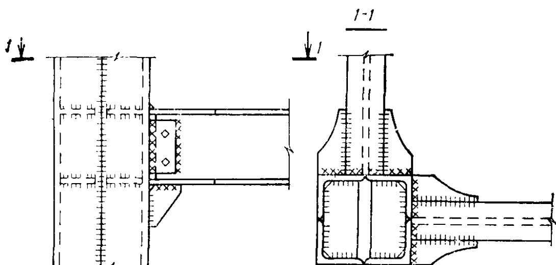
Рис. 25. Узел жесткого сопряжения ригелей с колонной
