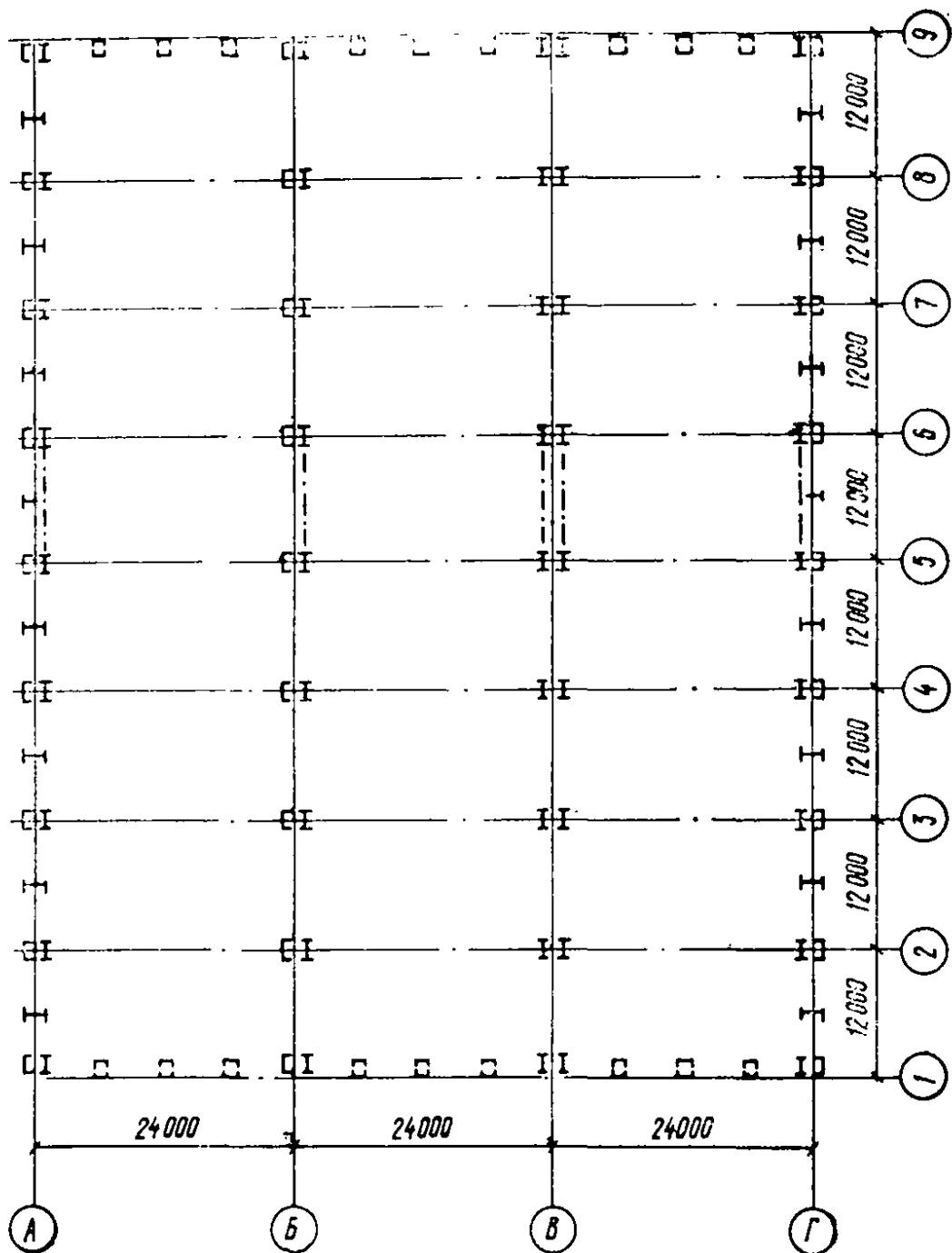
Рис. 41. План колонн здания
